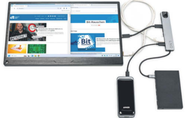
USB-C-Speisung funktioniert auch via USB-C-Dock. In diesem Beispiel erzeugt das Kabelsalat, weil das Display dann Bildsignale per HDMI und Strom per USB bekommen muss.
