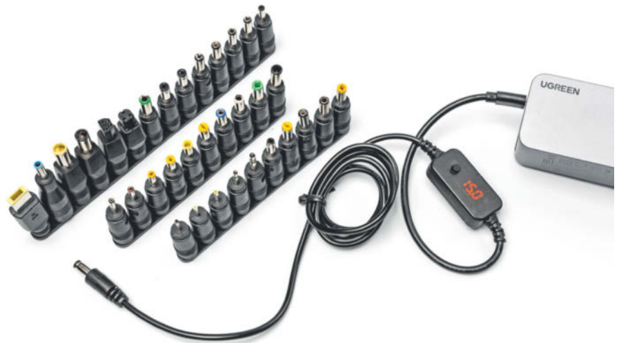
Adapterkabel mit PD-Controllerchip entlocken einem USB-C-Netzteil oder einer USB-C-Powerbank eine Spannung zwischen 5 und 20 Volt. Über Steckadapter lassen sich dann beliebige Geräte speisen, aber es gibt Risiken.
