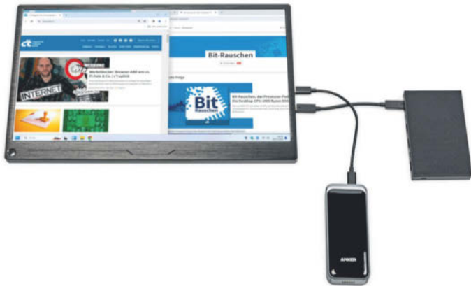
USB-C ermöglicht unterschiedliche Arten der Stromversorgung. Hier hängt die Powerbank am mobilen USB-C-Display, das wiederum den Mini-PC speist; im Aufmacherbild ists umgekehrt.
