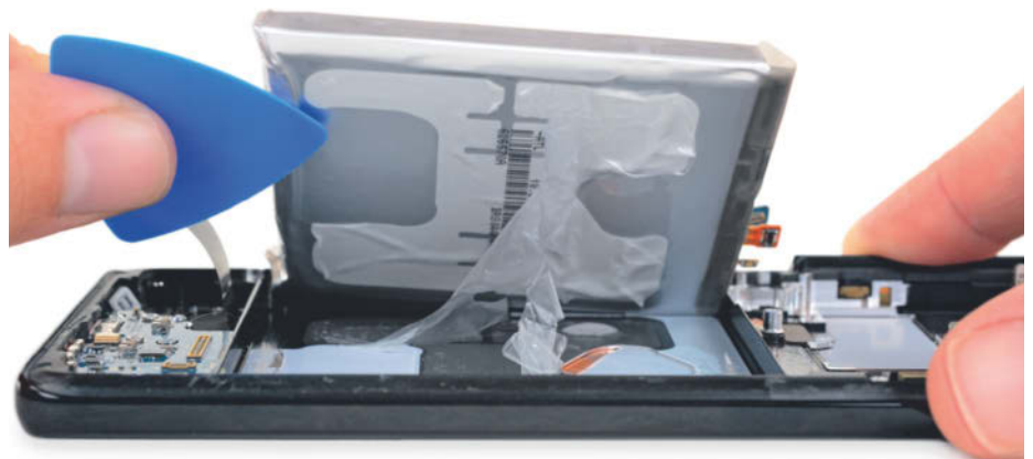
In Smartphones stecken flache Lithium-Polymer-Akkus. Durch das feste oder gelartige Elektrolyt kommen sie ohne feste Hülle aus.
