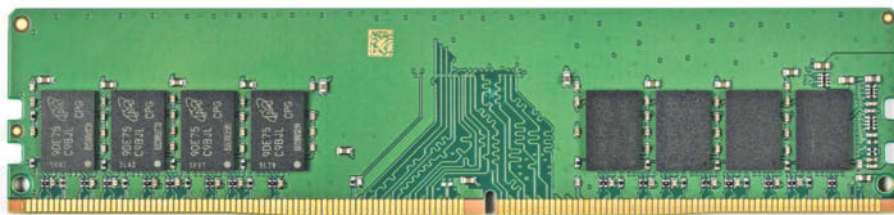
Ein Speichermodul (DIMM) hat stets 64 Nutzdatenleitungen, kann aber trotz gleicher Kapazität mit unterschiedlich vielen SDRAM-Chips bestückt sein. Es ist üblich, die Kapazität kompletter Module in Gigabyte (GByte, GB) anzugeben, die einzelner Chips hingegen in Gigabit (Gb, GBit).
