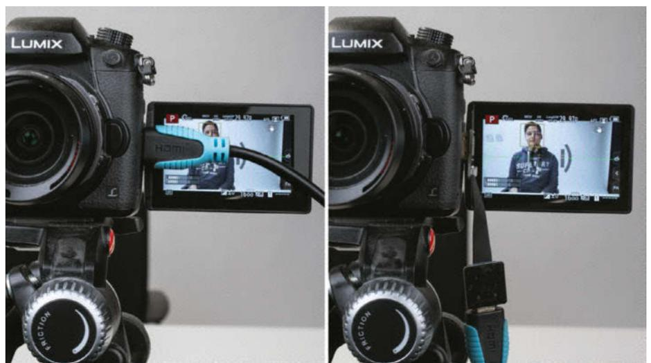
**Weil sich die Anschlüsse der Kameras meist auf der gleichen Seite wie das Display-scharnier befinden, verdeckt das HDMI-Kabel mit seinem ausladenden Stecker (links) den interessantesten Teil des Bilds. Mit einem HDMI-Folienkabel (rechts) hingegen ist die Sicht frei.**
