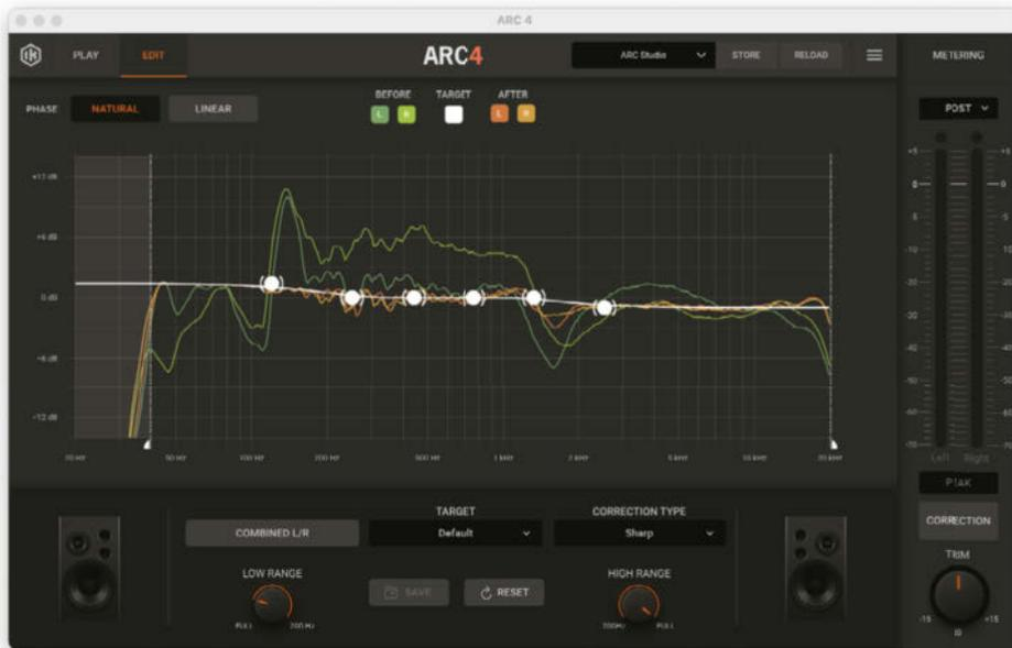
Die ARC-4-Software passt die Messdaten an das gewünschte Abhörsystem an und überträgt die Daten an die DSP-Box.
