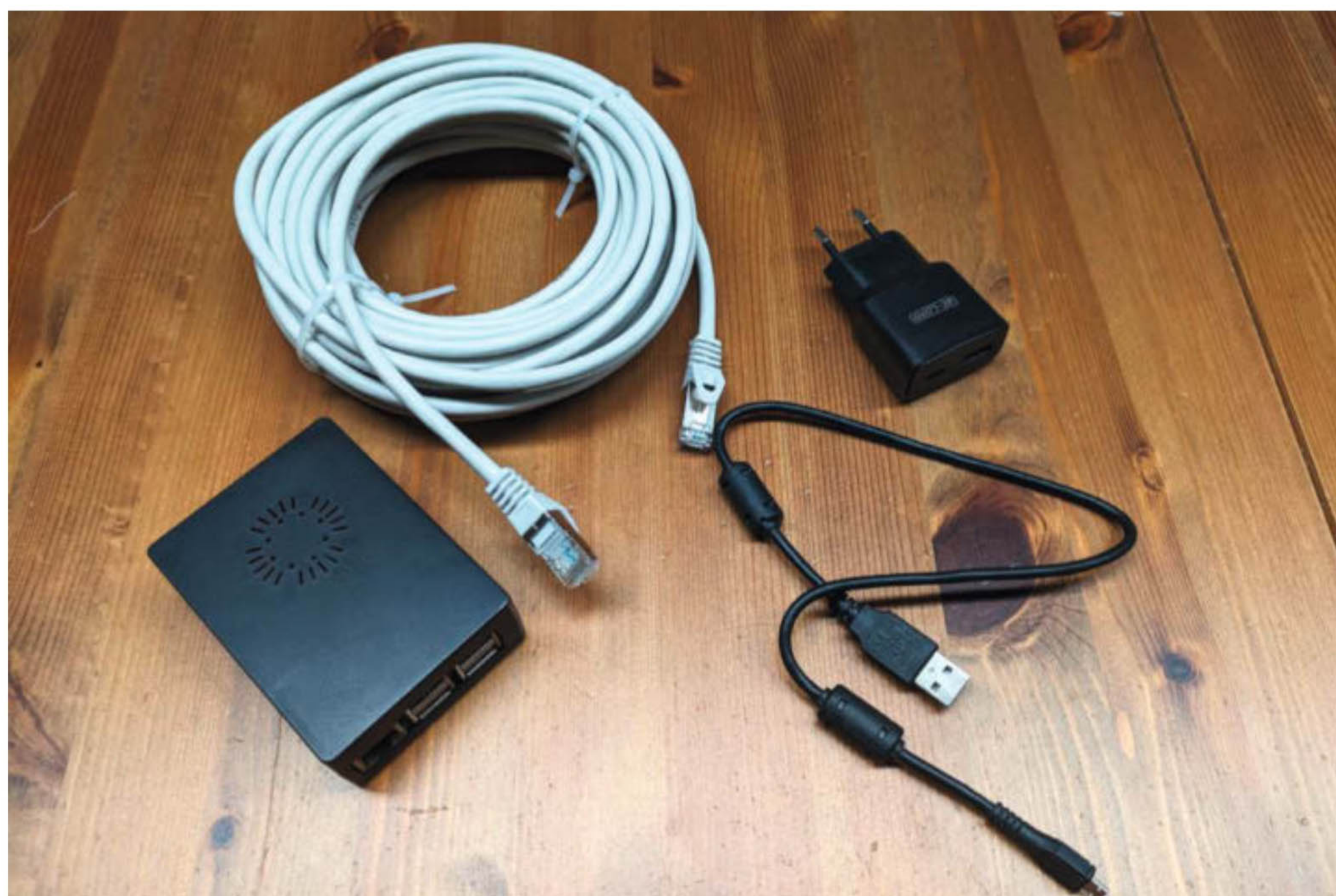
Bild 6: Raspberry Pi 3B mit Stromversorgung und LAN-Kabel
