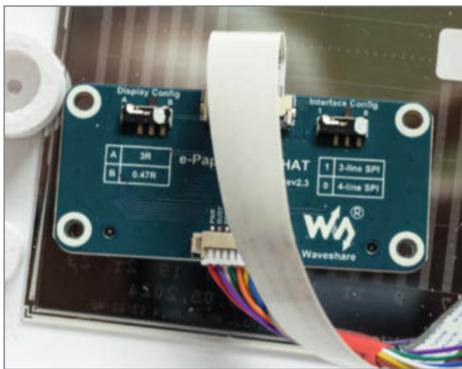
Bild 7: Ein ovaler Zapfen (10x11 mm) mit dazugehöriger ebenfalls leicht ovaler Buchse (10,5 x 11,5 mm Innen- und 20 mm Außendurchmesser) halten das Display auf dem gedruckten Rahmen. Auch gut zu erkennen ist das Interfacedisplay des ePaper mit den zwei Schalterstellungen (Display Config auf „B“ und Interface Config auf „0“).
