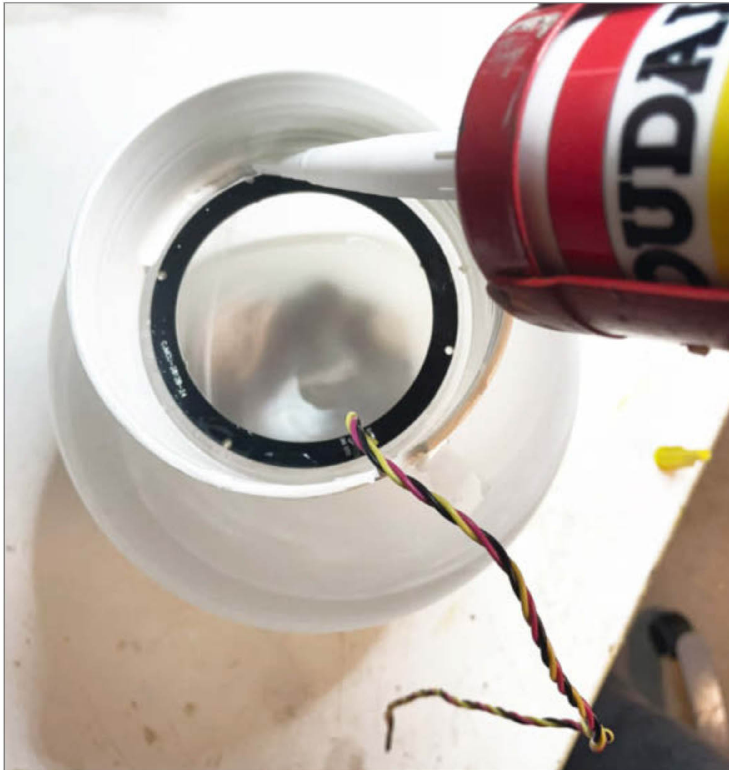
Bild 10: Jetzt noch schnell den LED-Ring in das Lüftungsrohr kleben.
