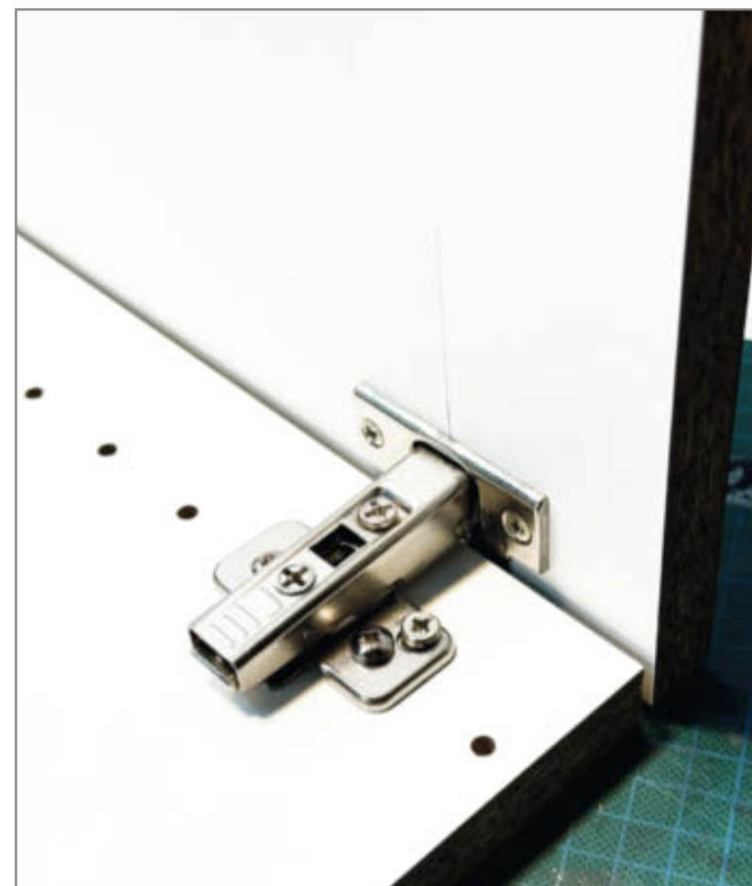
Blick in den fertigen Schrank, auf das Topfscharnier. Das Ergebnis sind präzise passende Lochreihen, Scharniere und Schubladenauszüge, ohne einmal gemessen zu haben.
