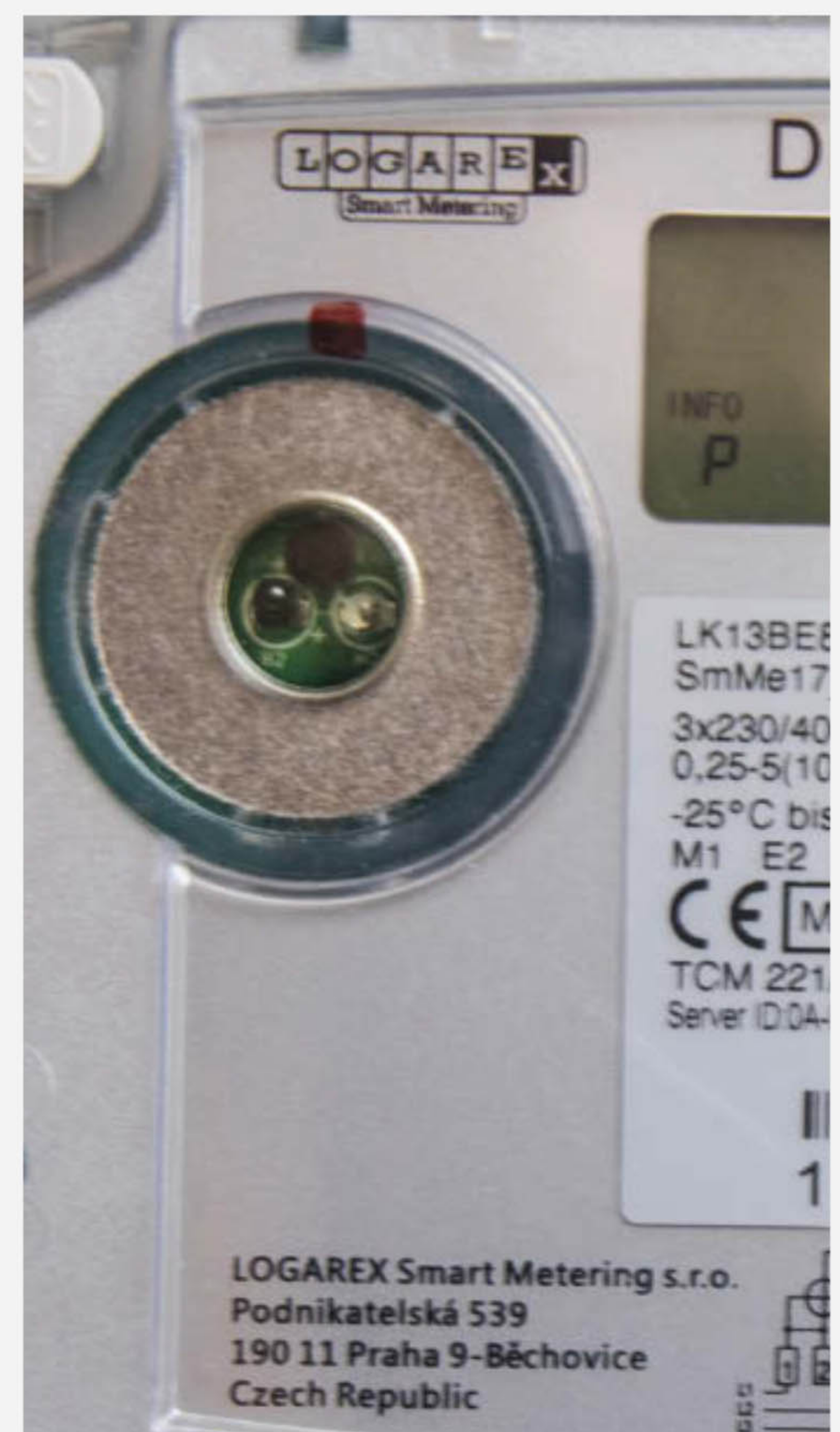
Hier ist die Sende- und Empfangsdiode auf dem Stromzähler gut zu erkennen.
