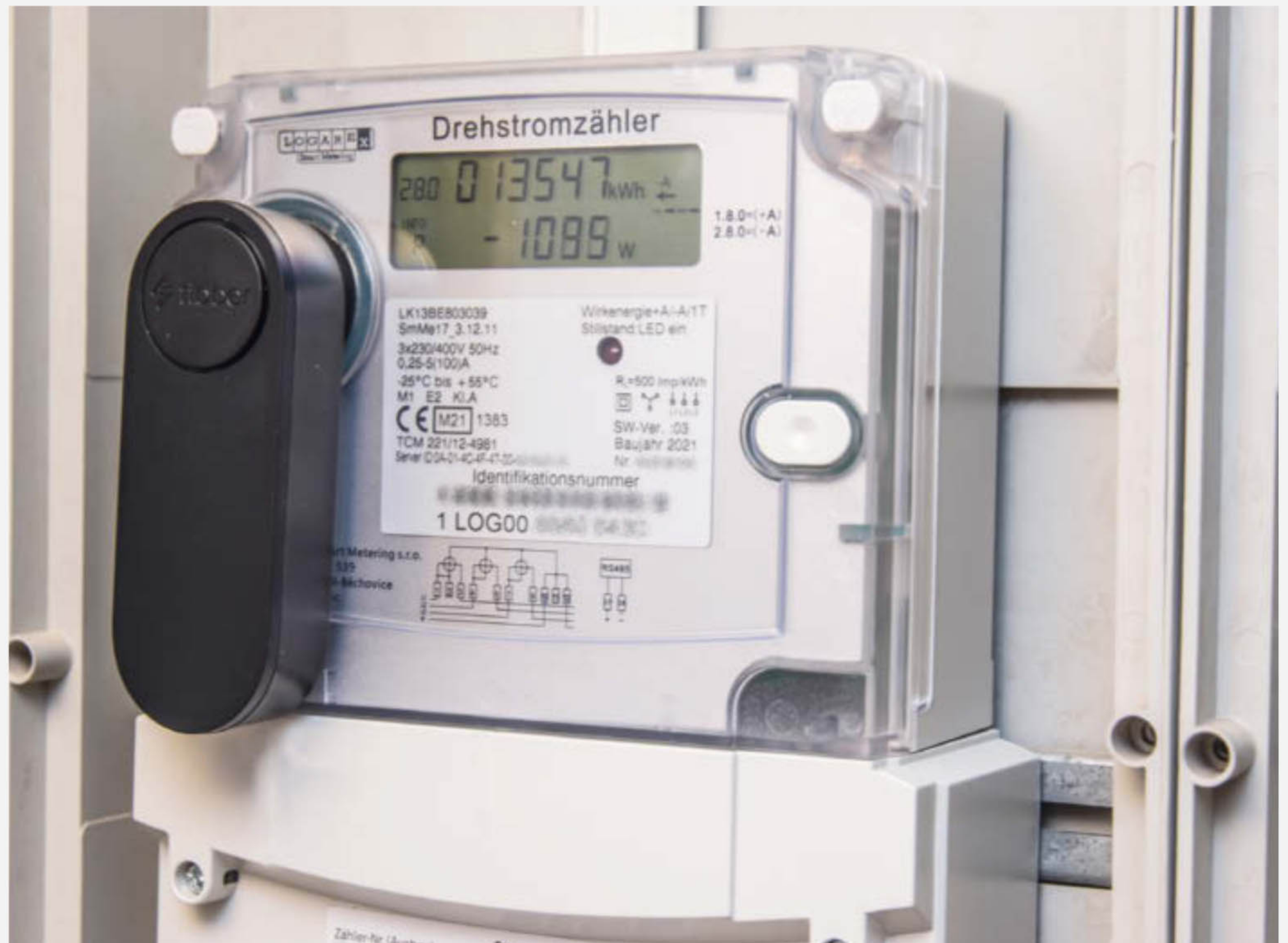
Tibber Pulse haftet magnetisch am Zähler.
