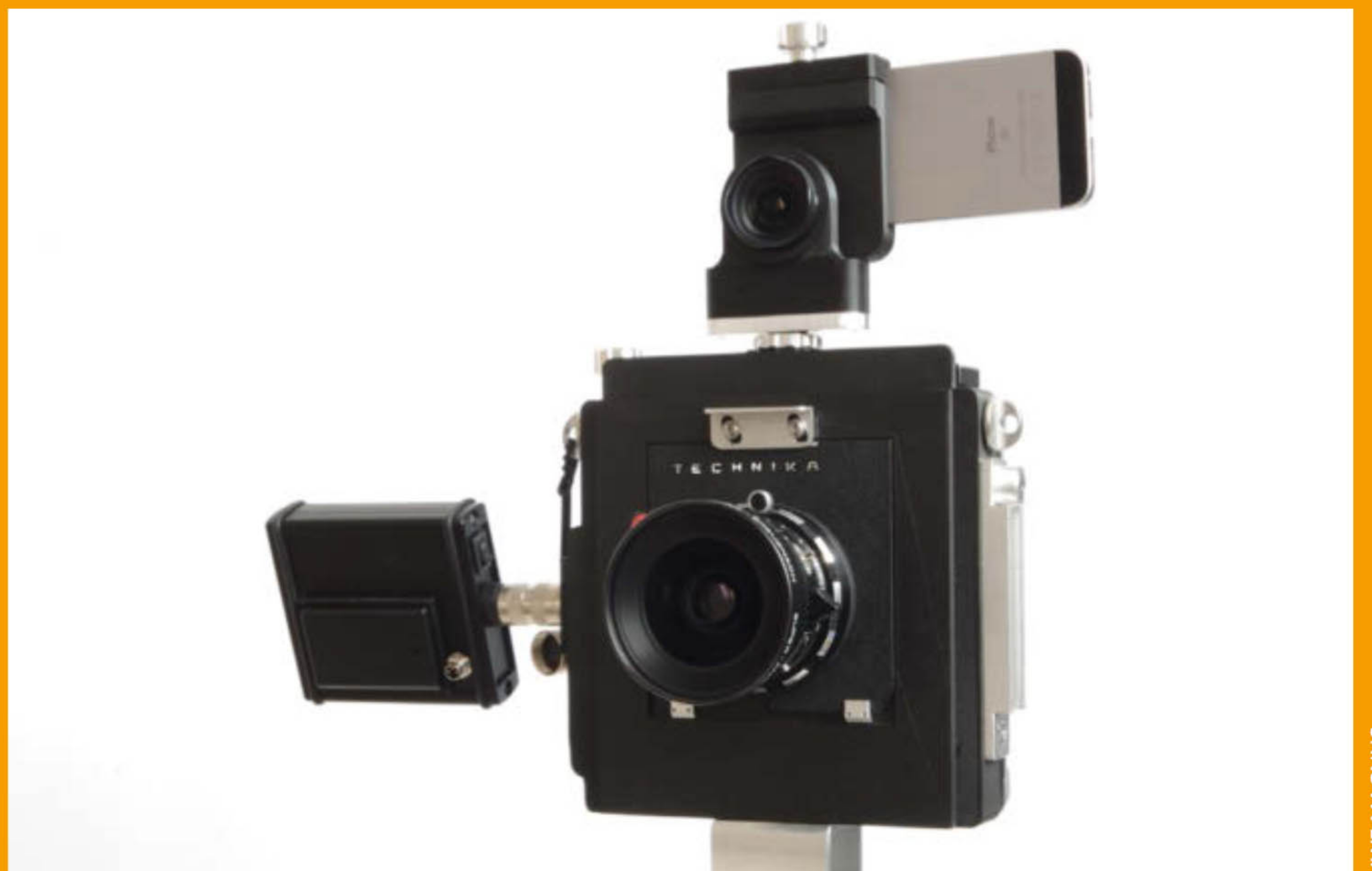
Kamera von vorn: Am schwenkbaren iPhone-Sucher erkennt man die Aufsatzlinse.
