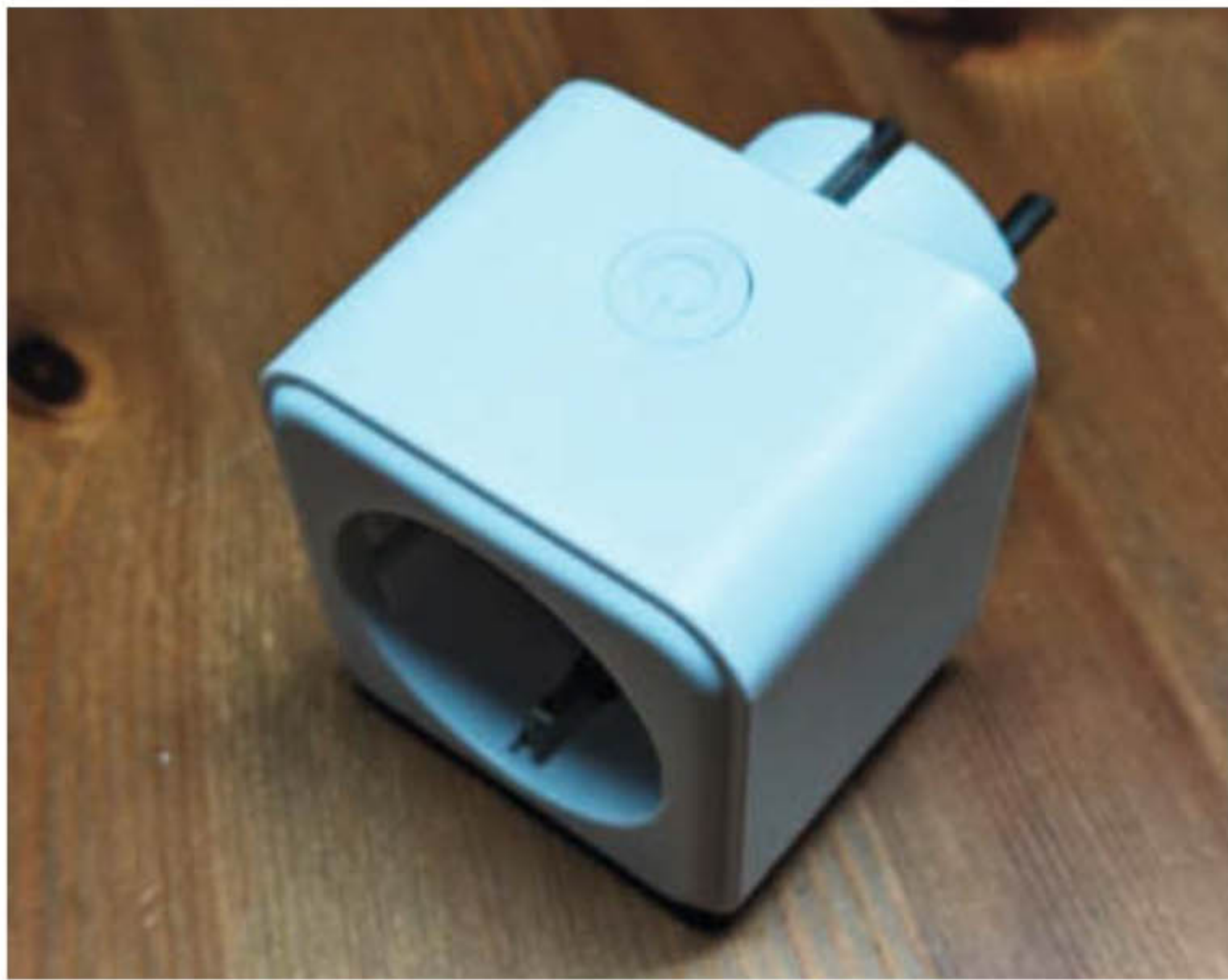
Bild 14: Alternativ zur Wemos-Relaiskarten-Kombination kann auch eine Schaltsteckdose verwendet werden, falls sie sich noch mit Tasmota flashen lässt.
