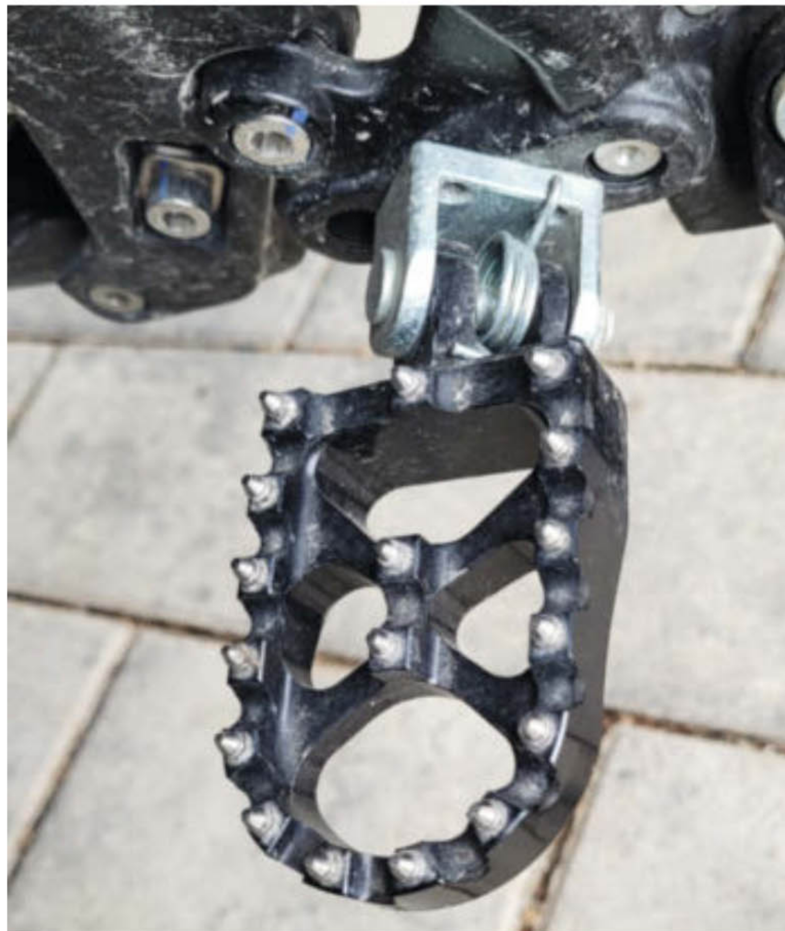
Mit mehr Fläche und Spikes bieten neue Fußrasten einen deutlich sichereren Halt.
