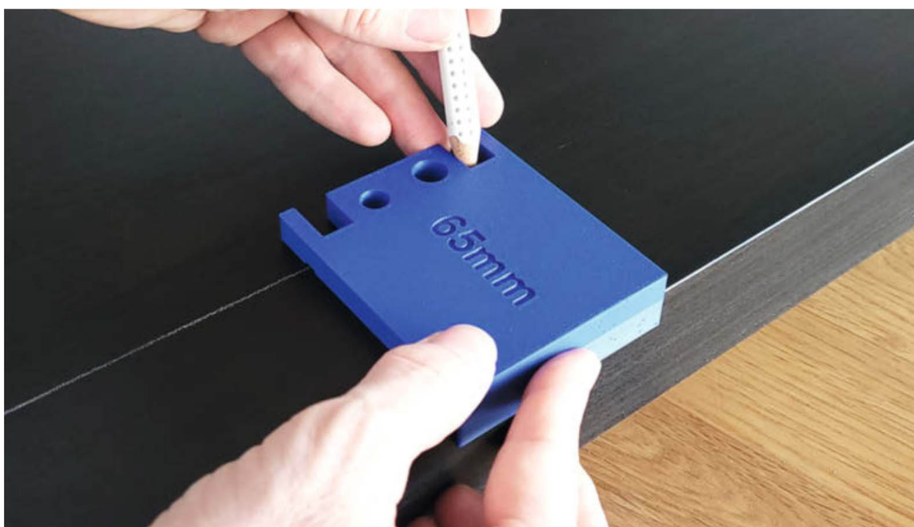
Abbildung 7: Mit dem Werkzeug aus dem 3D-Drucker lässt sich schnell, einfach und präzise eine Schnittlinie für die Stichsäge markieren.
