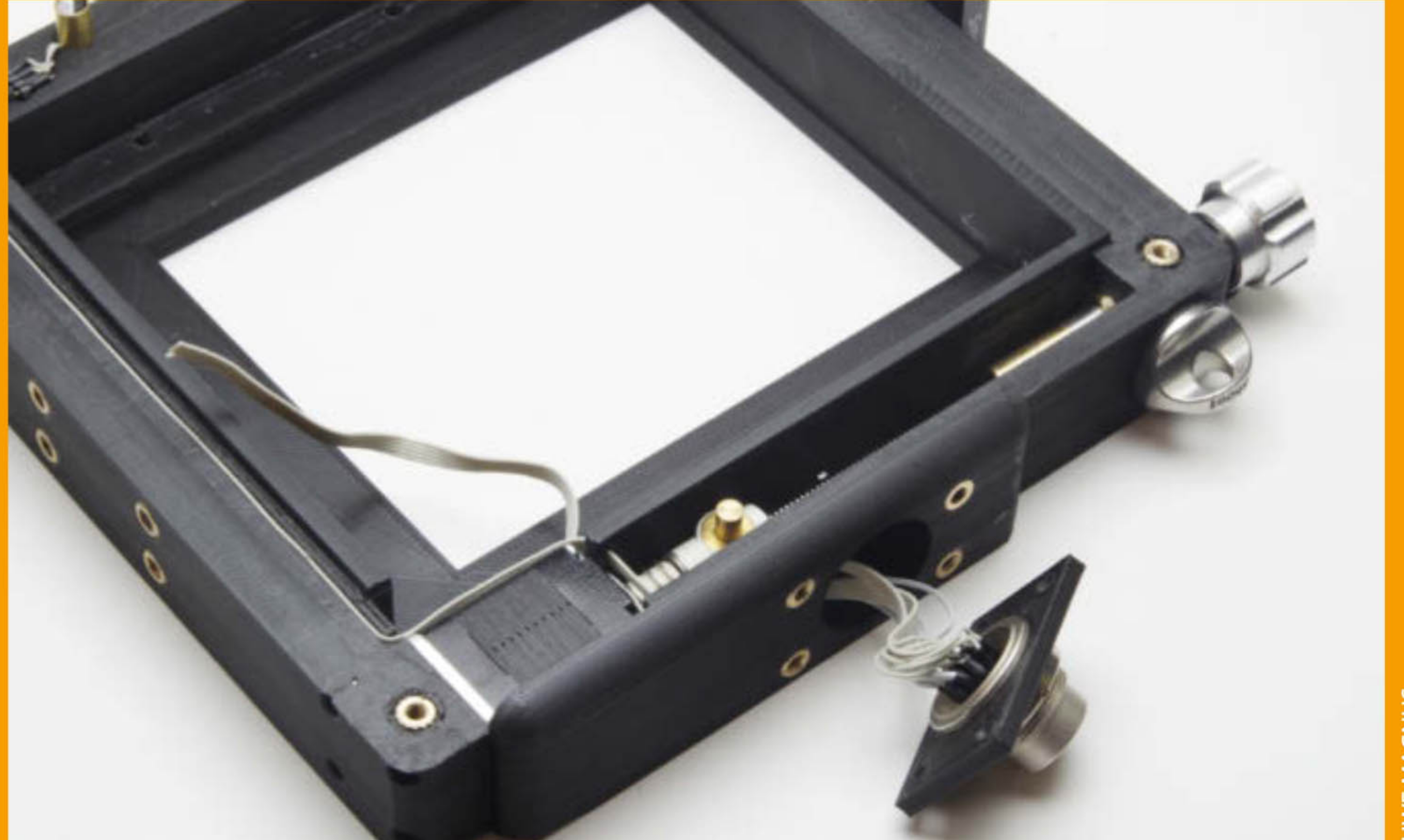
Der Kamerakörper mit Schrittmotor und Anschlussstecker für das Bedienteil. Alle Verschraubungen sind mit Messing-Gewindeeinsätzen verstärkt.
