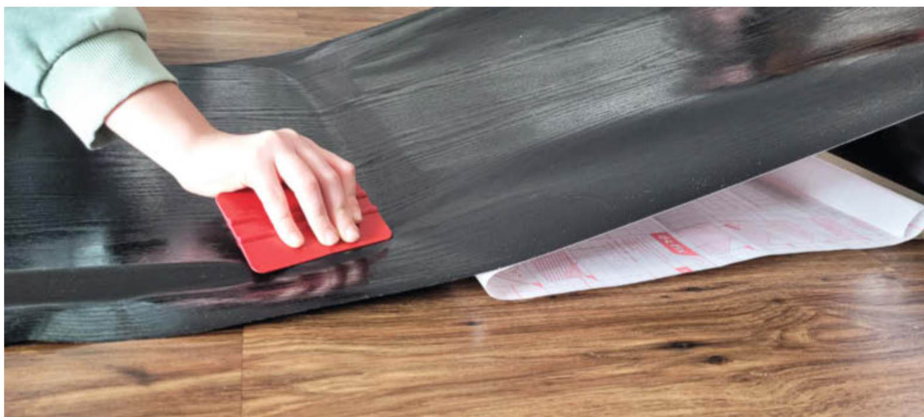
Abbildung 5: Die Tischunterseite wird mit d-c-fix-Klebefolie beschichtet. Ein Spachtel hilft, allfällige Luftblasen nach außen zu streichen.
