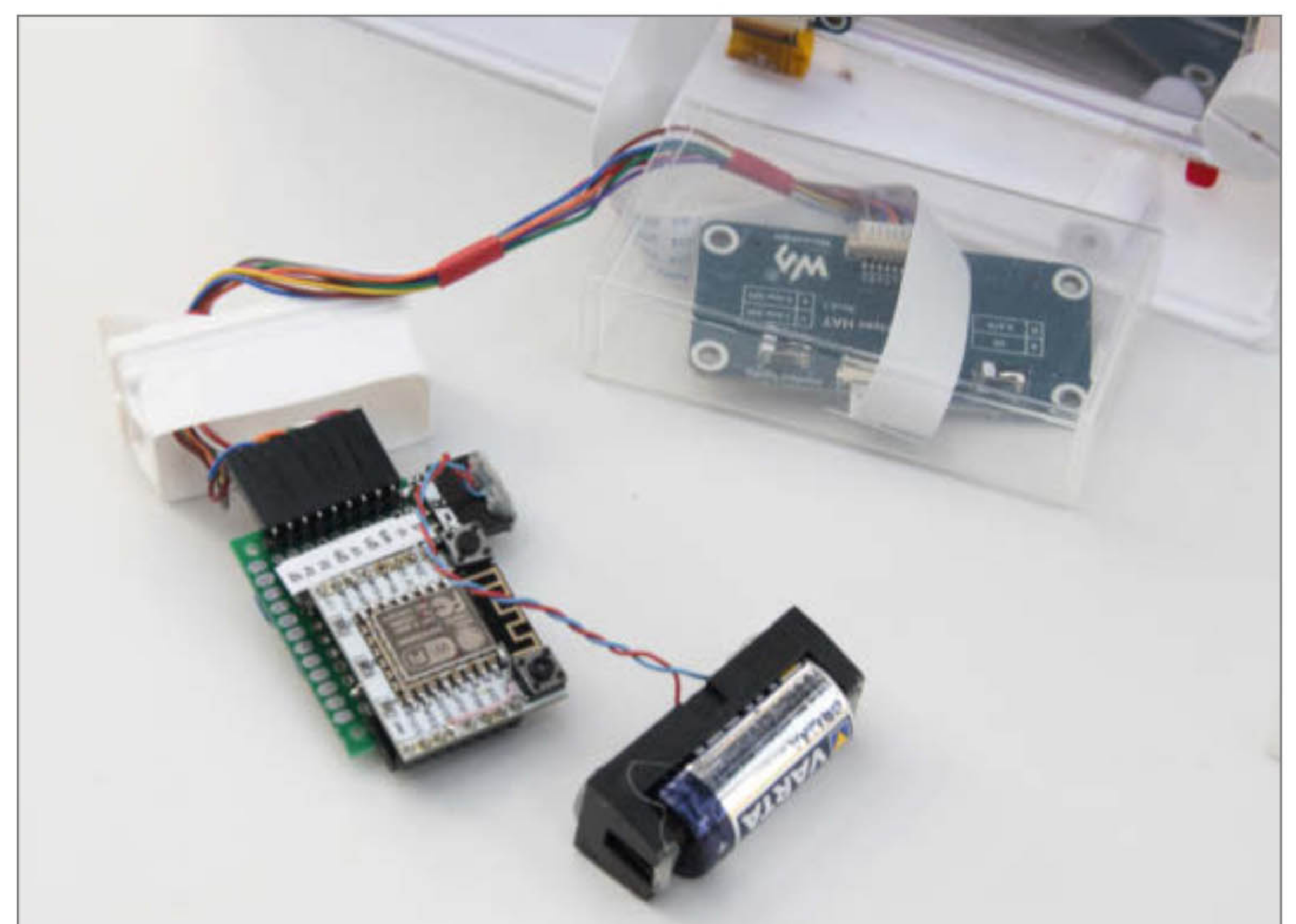
Bild 5: Der ESP wird auf die kleine weiße Adapterplatte gelötet, die von 2 mm Raster auf 1/10" Raster umsetzt. Die Platine hat auch zwei Pull-up-Widerstände in SMD und hier werden auch die Reset- und Programmier-tasten angelötet.
