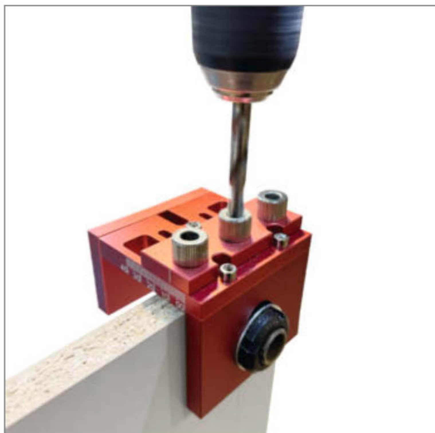
Diese Schablone (Pocket Hole Jig Set) ist von zwei Seiten nutzbar. Zunächst wird wie abgebildet in die Stirnseite gebohrt, anschließend durch die dunkle Hülse auf der rechten Seite in die Fläche. Die Bohrungen dienen zur Aufnahme von Einschraubdübel und passendem Exzenter, bekannt von schwedigen Schränken.
