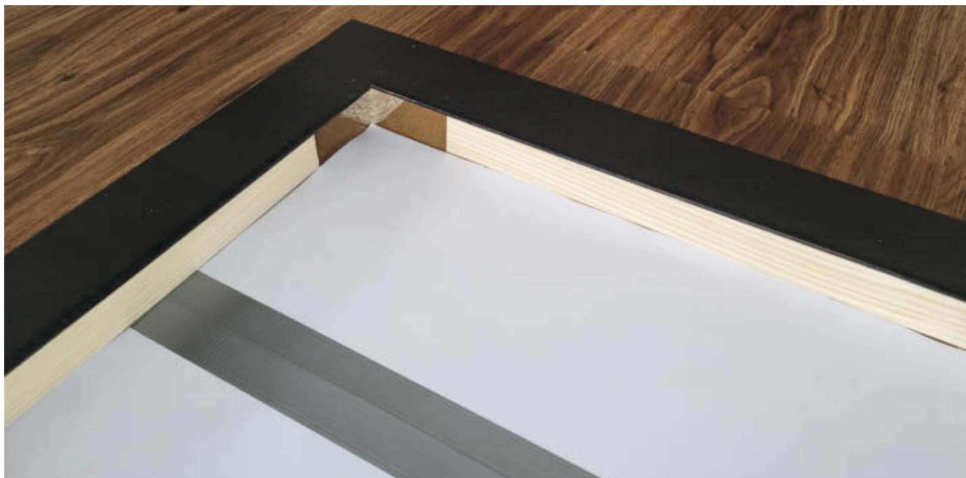
Abbildung 10: Die ausgeschnittene Tischplatte. Im Rahmen befinden sich die Kanthölzer. Den Boden habe ich zur Schalldämmung mit Moosgummi ausgelegt.
