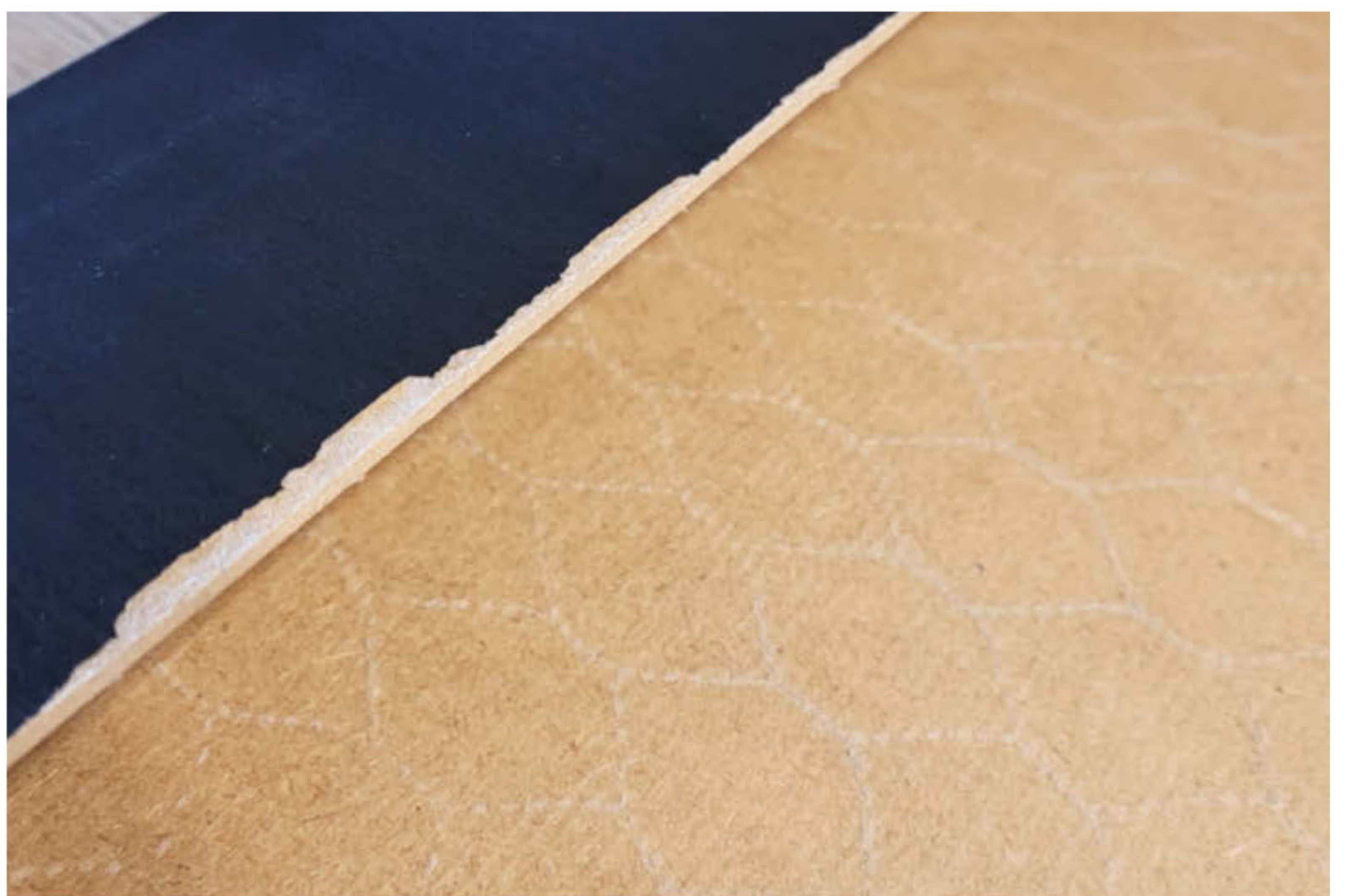
Abbildung 8: Die LACK-Tische sind innen mit einem Wabenmuster aus Pappe gefüllt.
