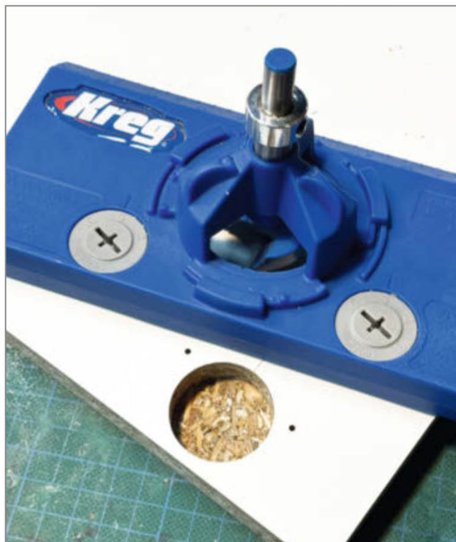
Wer viele Topfscharniere einlassen muss, wird diese Bohrhilfe (Kreg Bohrschablone für Topfscharniere) zu schätzen wissen. Der Forstnerbohrer samt Tiefenstopp ist im Set enthalten.
