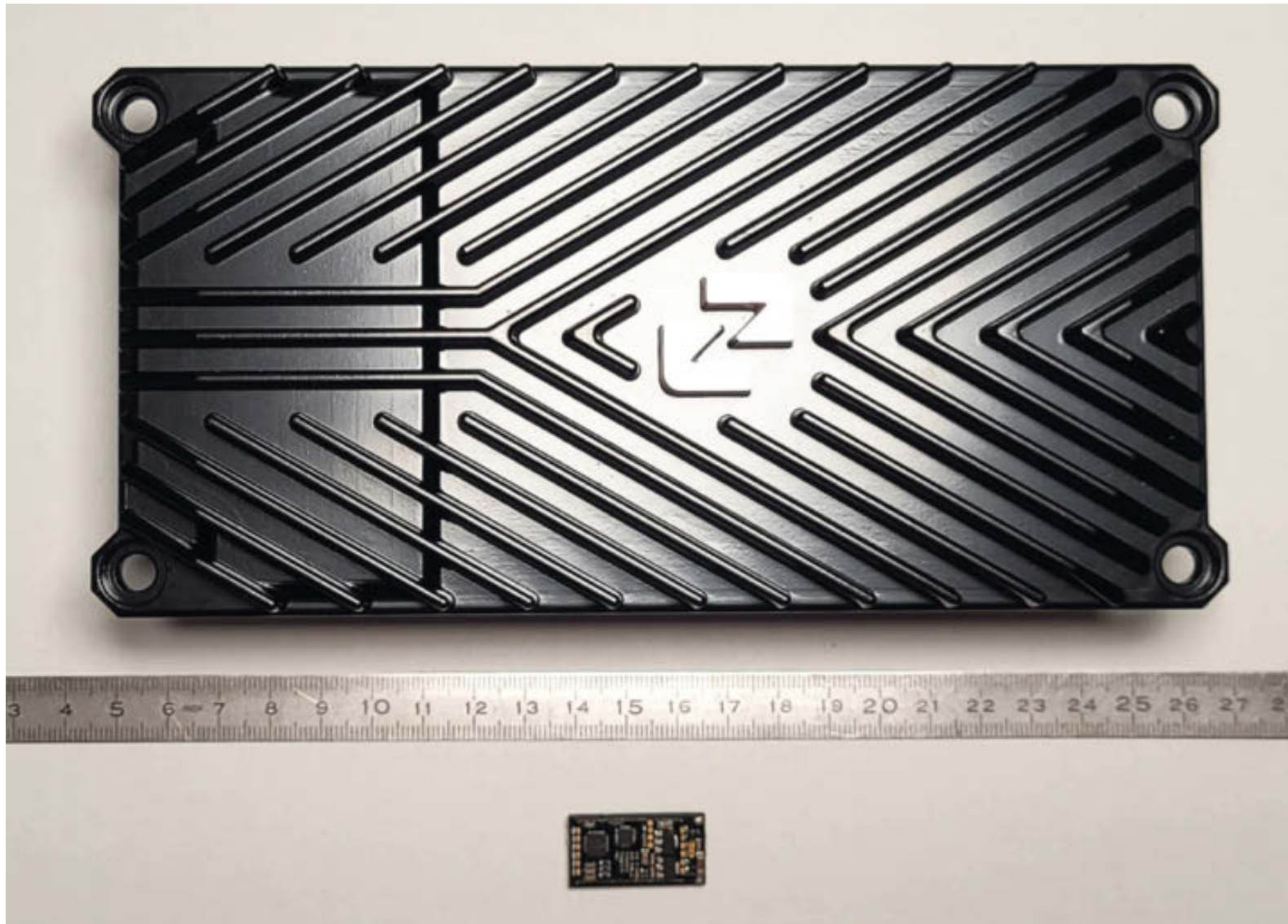
Selbst wenn der neue Controller im Vergleich zu einem Copter ESC riesig wirkt, ist er für seine Leistung winzig.
