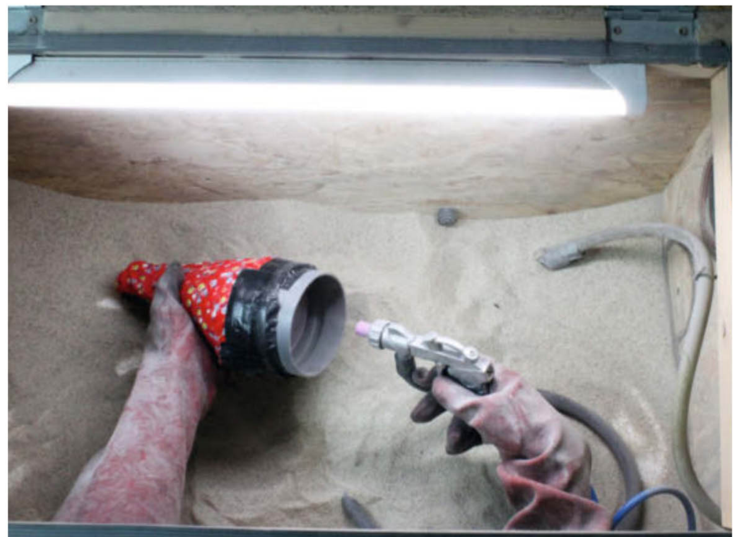
Bild 2: Ein Stück HT-Rohr begrenzt die Wirkung des Sandstrahlers, das rot-weiße Tuch schützt den Rest des Kolbens.
