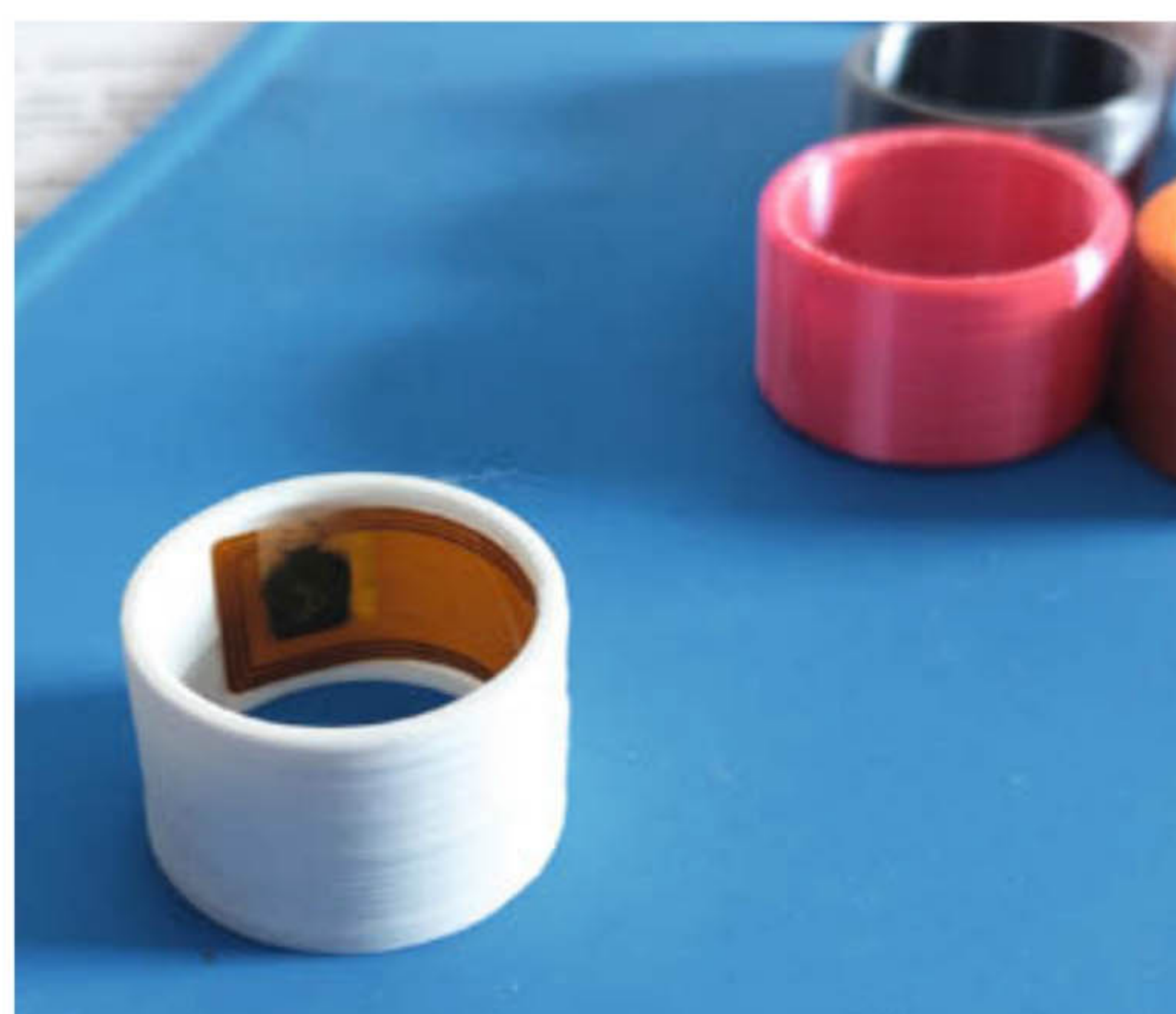
Bild 4: NFC-Chip im Testring
