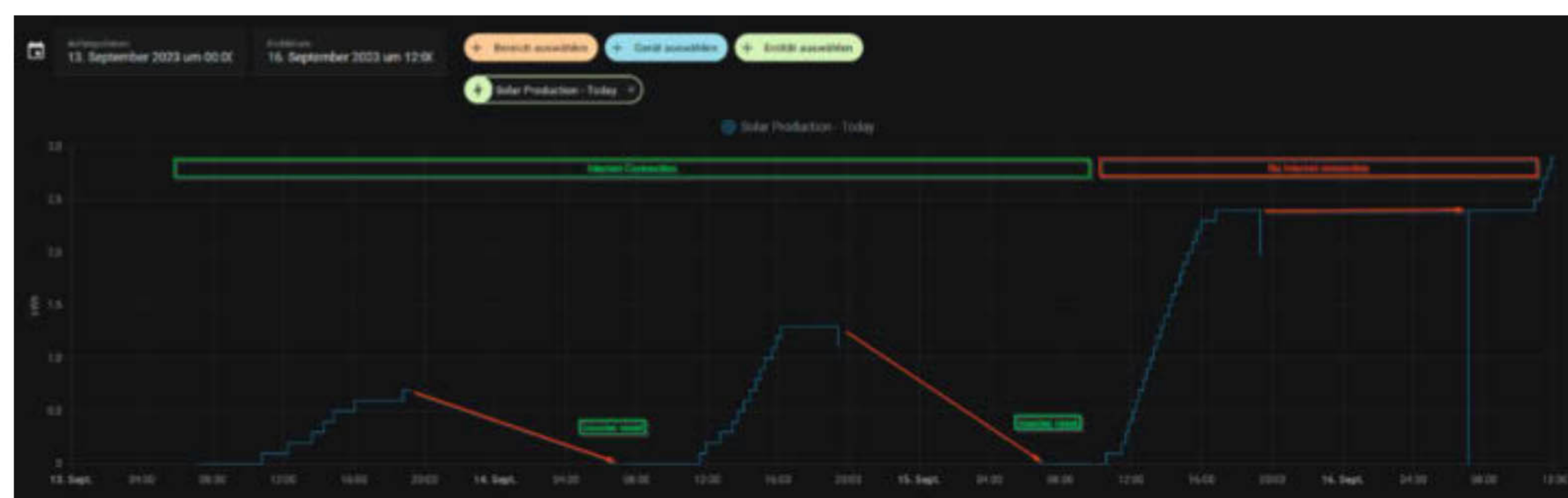
Bild 5: Links zwei Tage mit, rechts ohne Internetverbindung. Ohne setzt sich der Zähler für die täglich erzeugte Energie nicht zurück.
