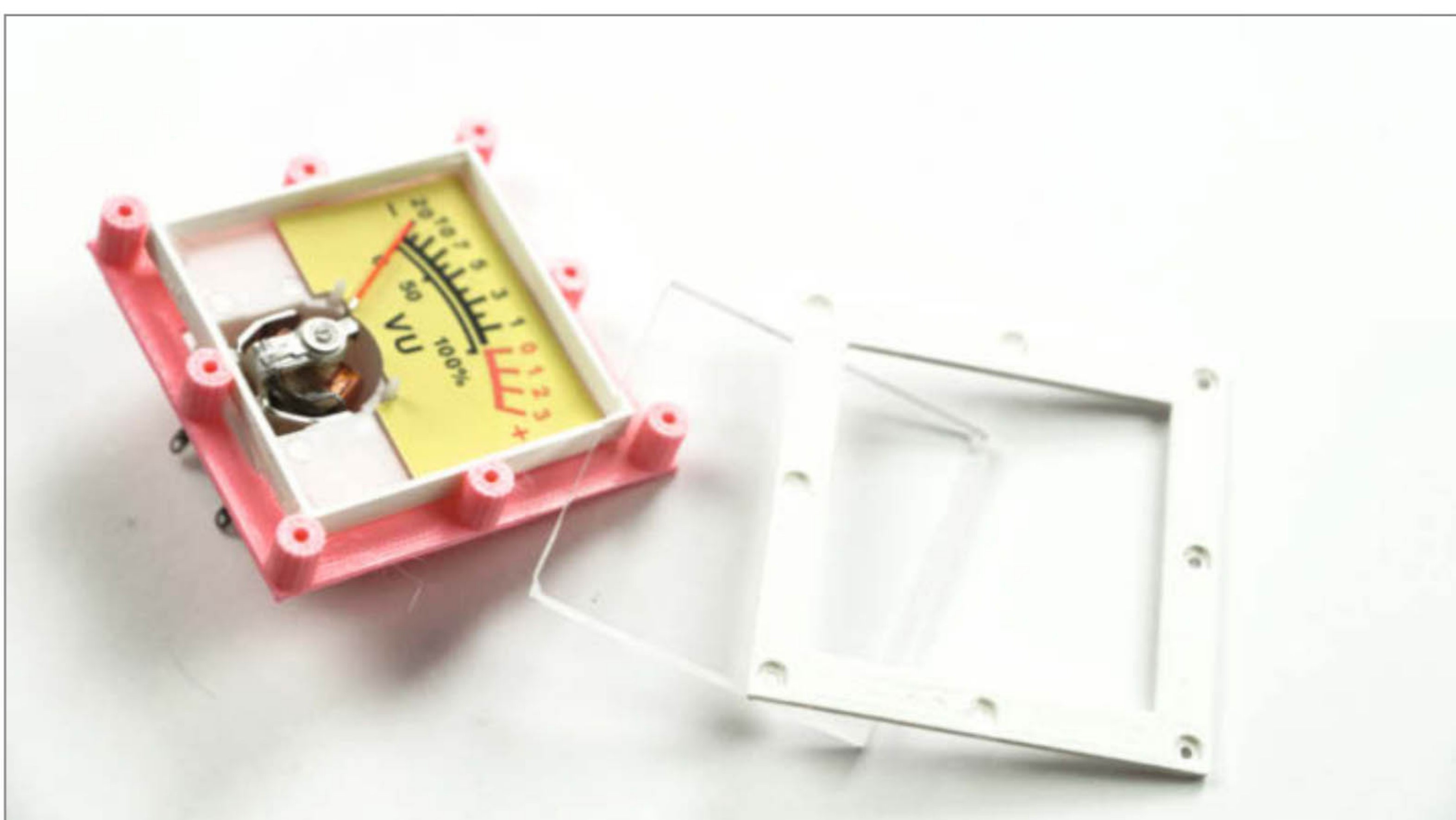
Bild 16: Einbaurahmen für VU-Meter
