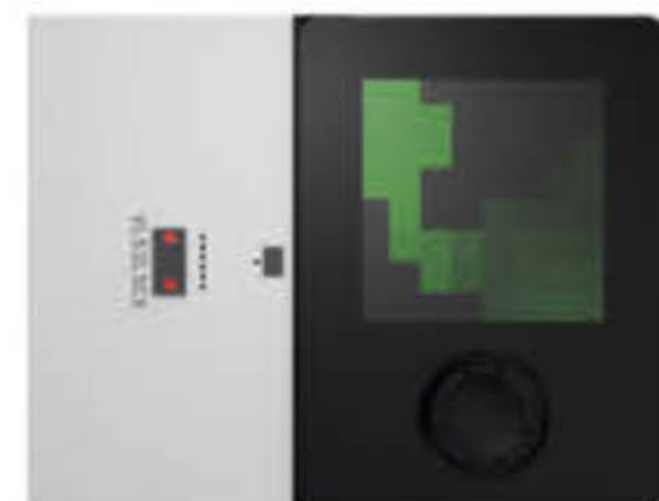
Überwache deine Umgebung mit der Tiefenbildkamera (8x8-Pixel)
