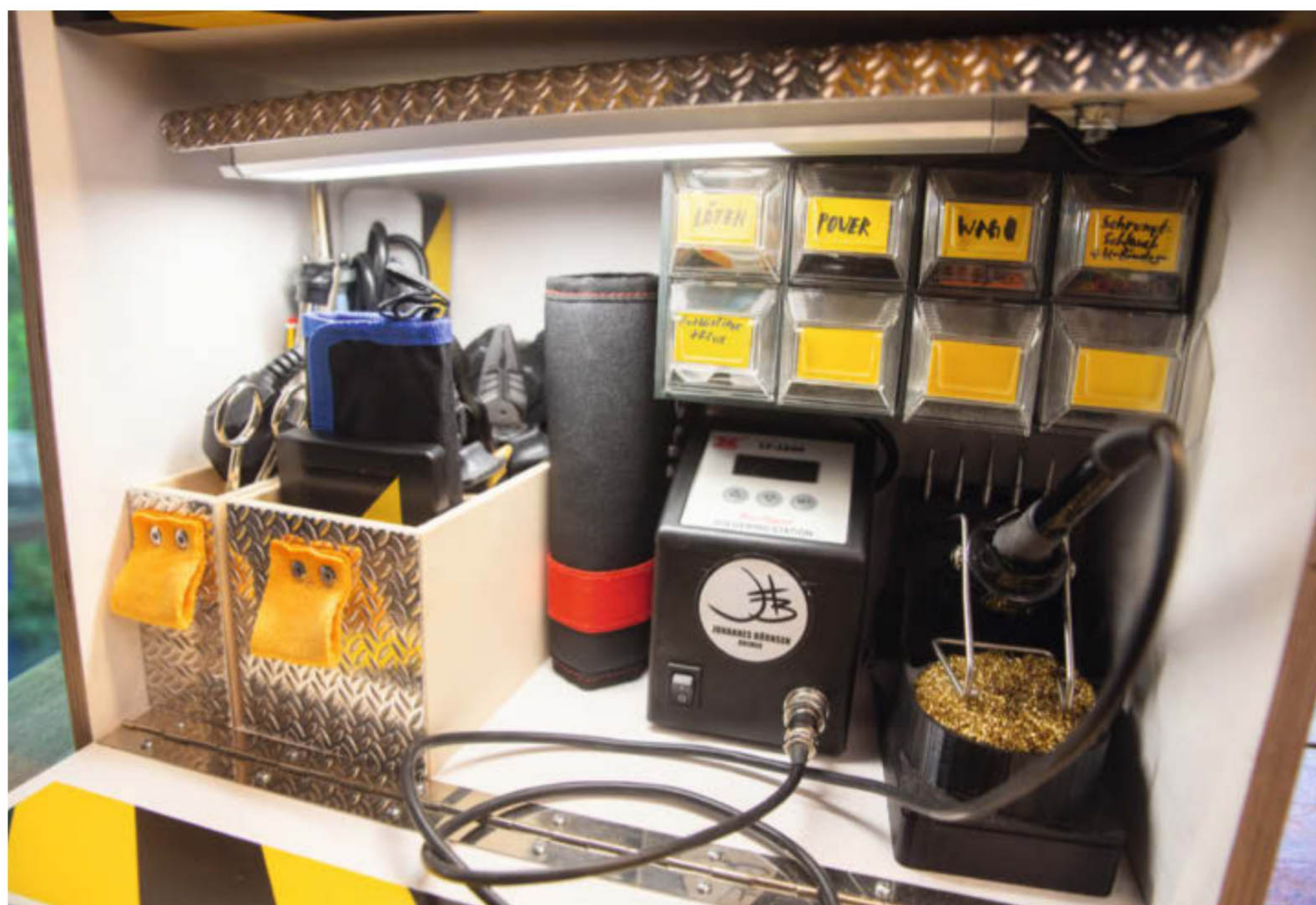
Handwerkzeug und Lötcolben finden im unteren Teil Platz. Zubehör und Verbrauchsmaterial lagern in kleinen Schubladen. Die hinter Riffelblech versteckte Leuchte lässt sich nach vorne schwenken ...
