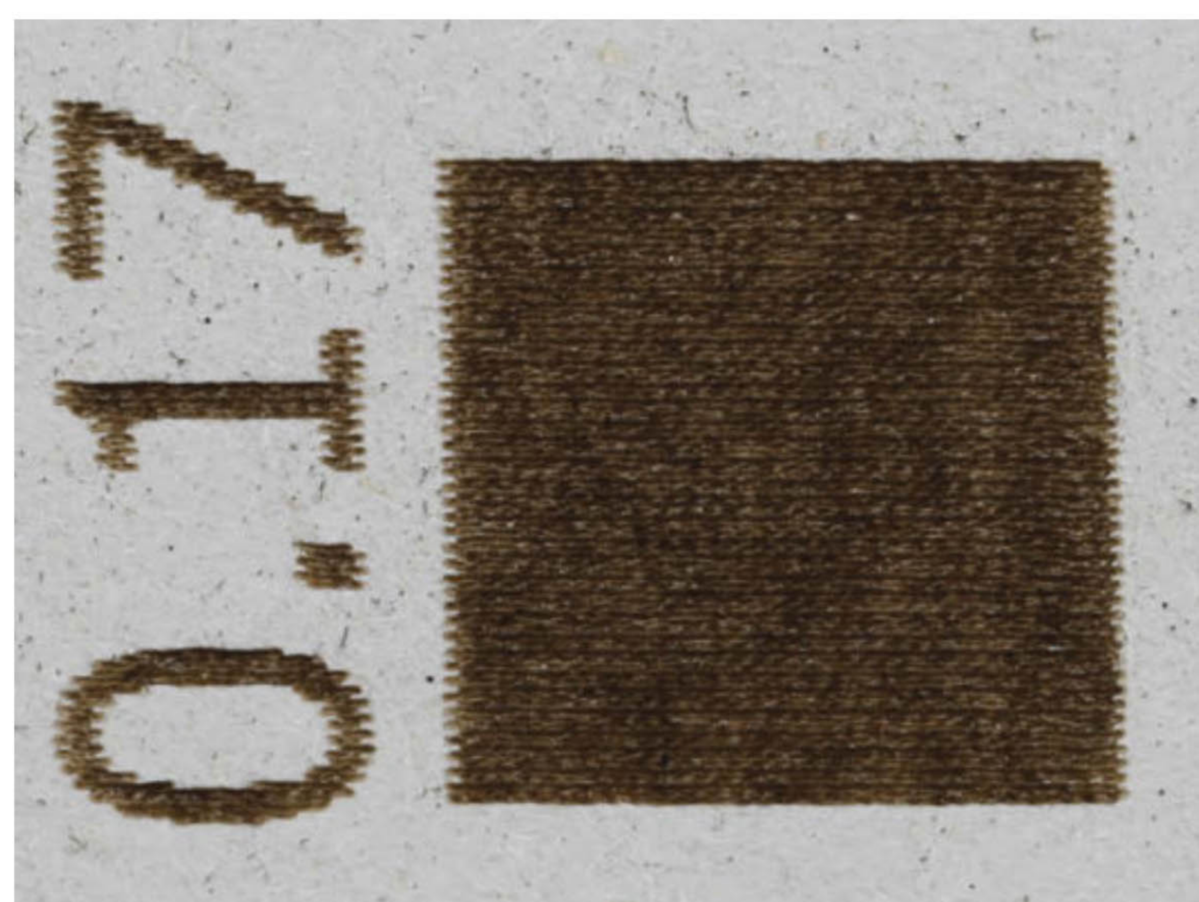
Bild 11: Die helleren Linien zeigen einen zu großen Zeilenabstand.
