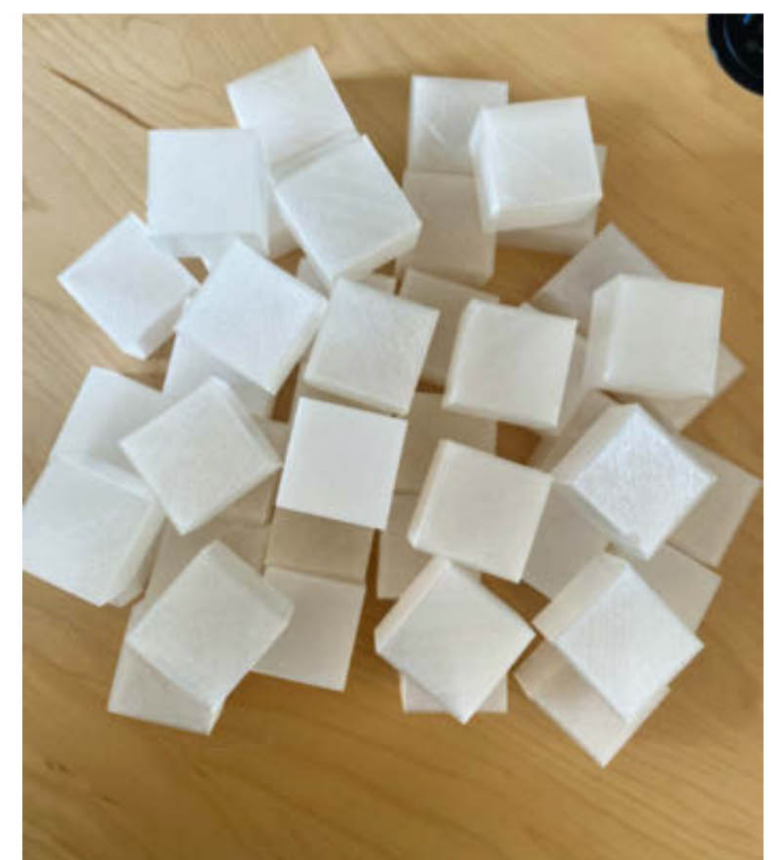
Bild 2: Gedruckte Pixel-Boxen aus transparentem Filament
