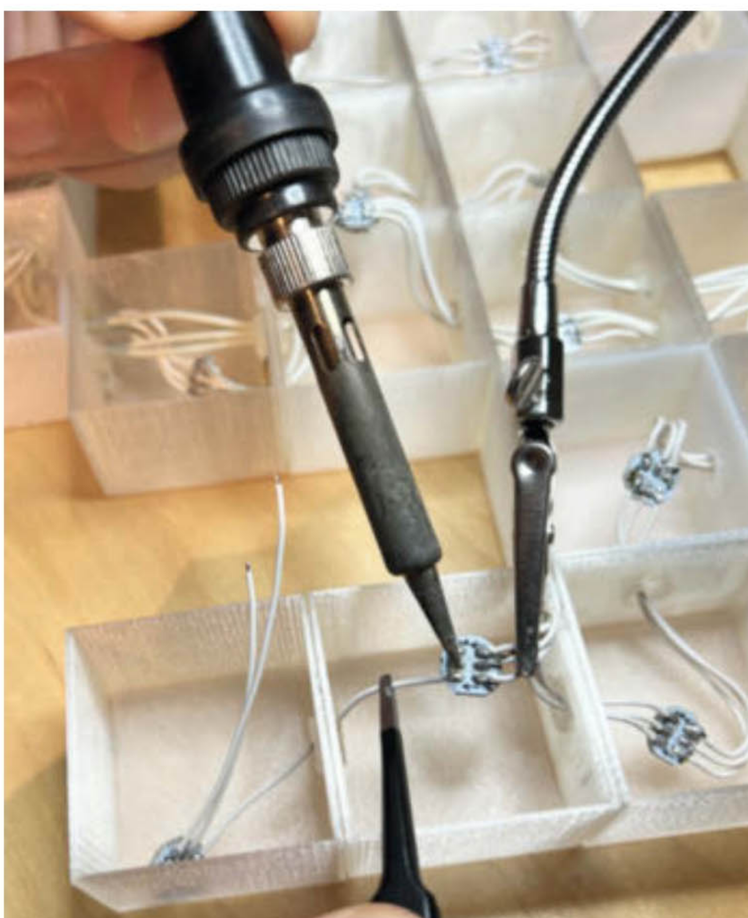
Bild 4: Das Verbinden der einzelnen LEDs dauert eine Weile.
