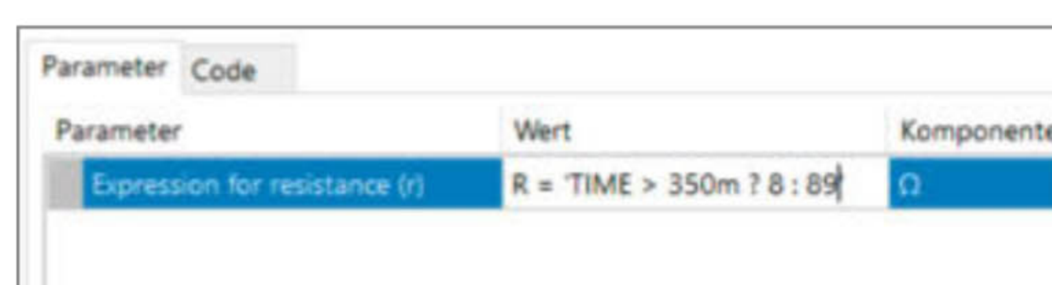
Bild 4: SPICE-Code um nach 350ms den Widerstandswert zu ändern.
