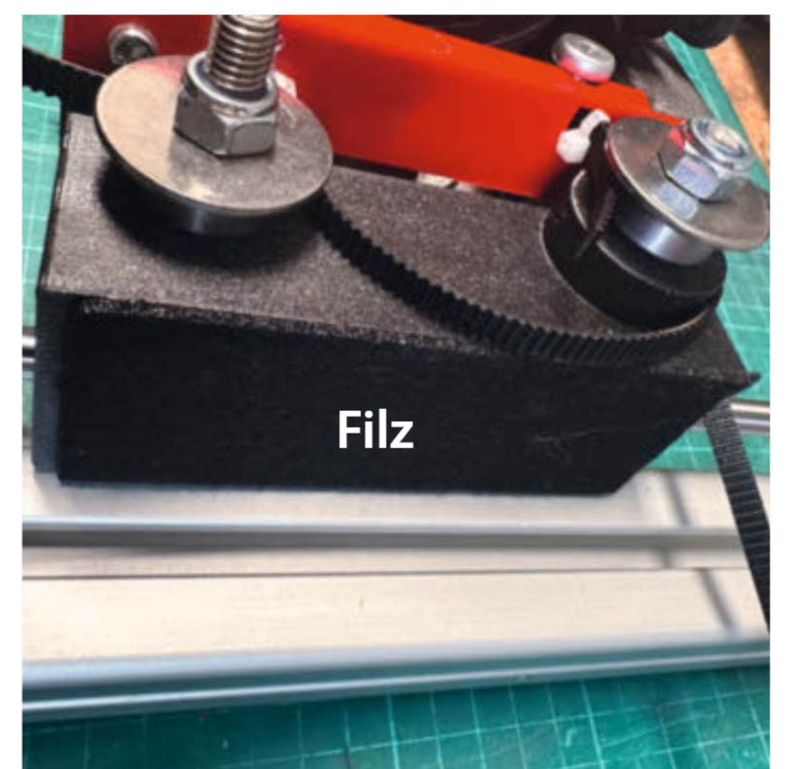
Bild 4: Filz an der Außenseite des X-Achsen-Blocks als Gleithilfe
