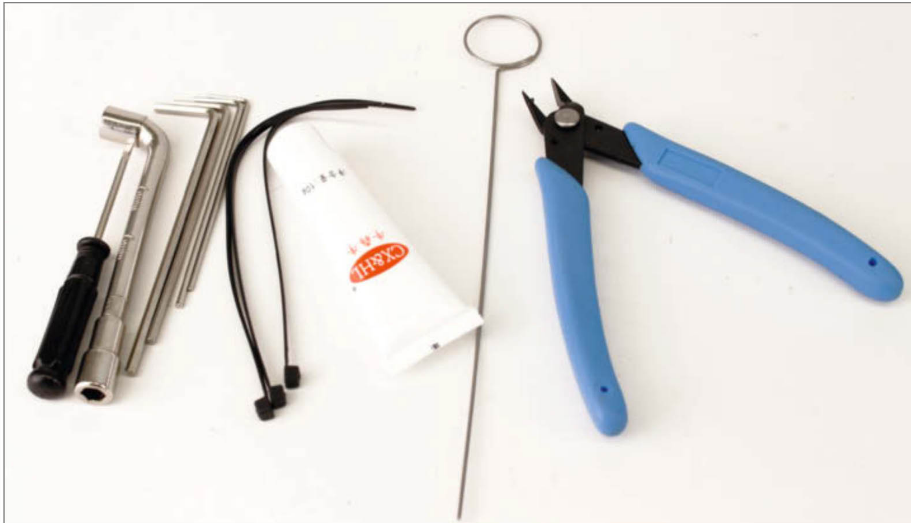
Bild 2: Das Zubehörpaket des Ender-3: In der weißen Tube ist Schmierfett, mit dem man die Stahlwellen des Druckers ab und zu sparsam versorgen sollte.
