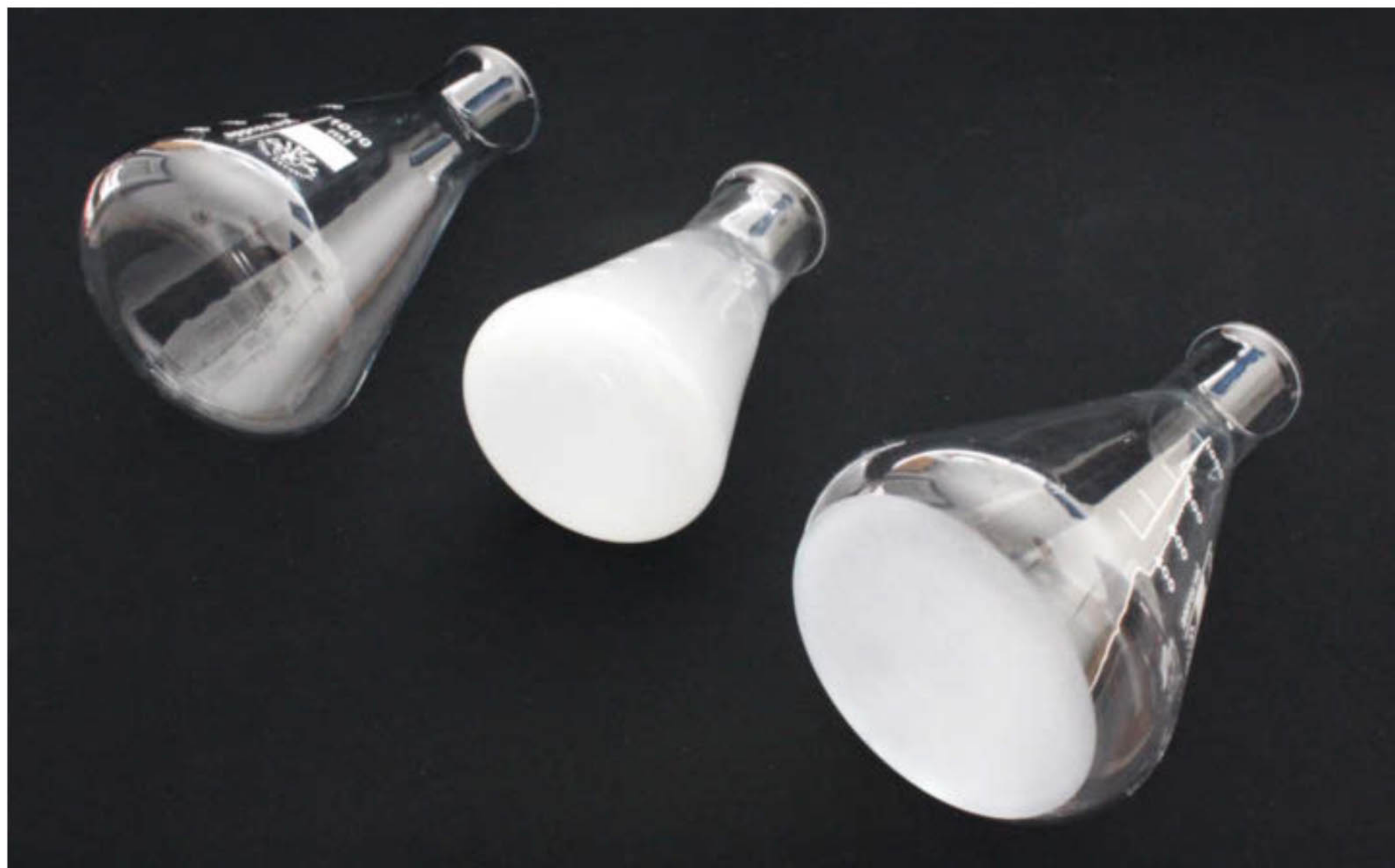
Bild 4: Von links nach rechts: Erlenmeyerkolben unbearbeitet, von innen sandgestrahlt, nach Abkleben von außen sandgestrahlt
