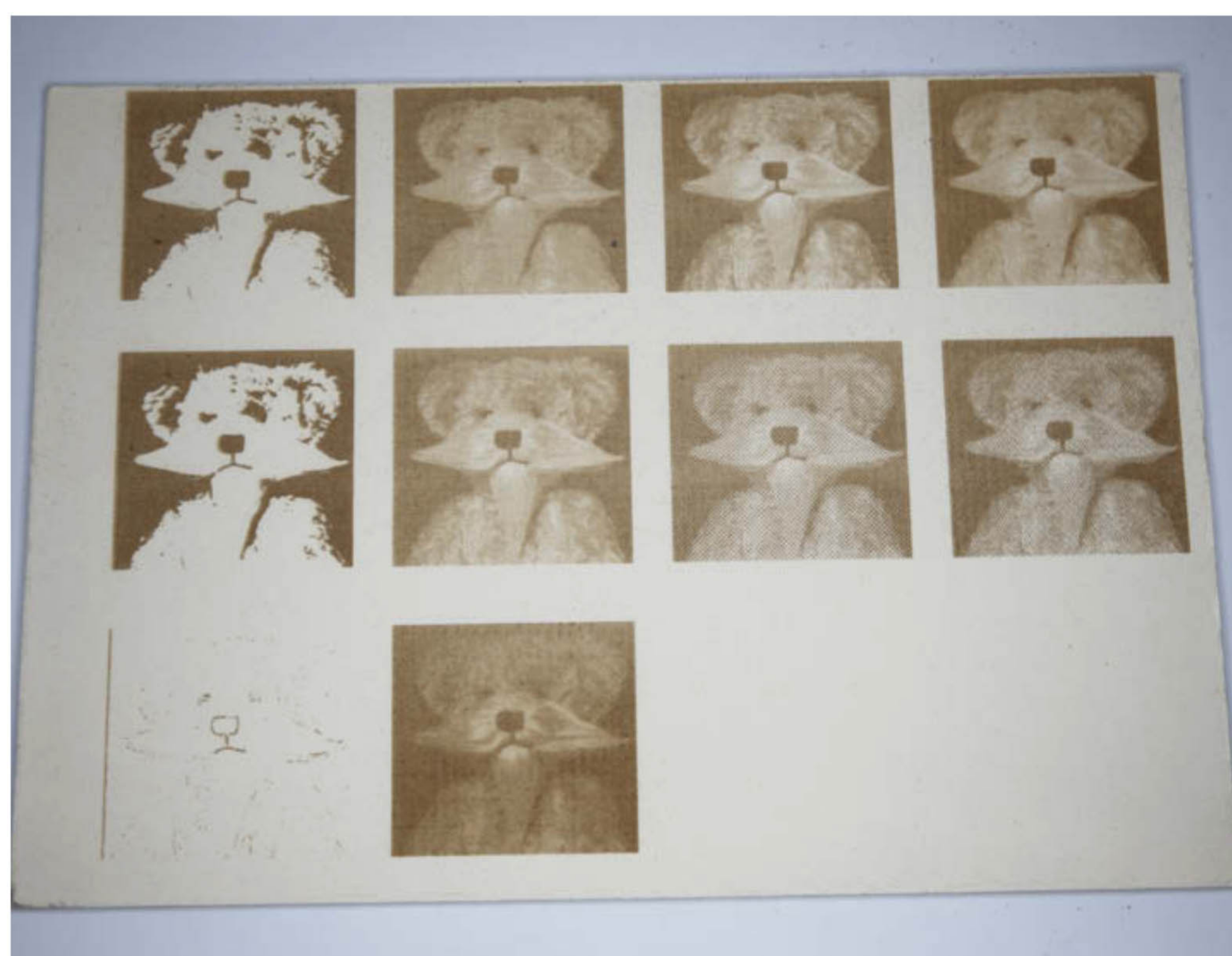
Bild 20: Willy in den zehn Bildmodi graviert (von oben links nach unten rechts): Schwelle, Geordnet, Atkinson, Dithering, Stucki, Jarvis, Newsprint, Halfton, Sketch und Graustufen.
