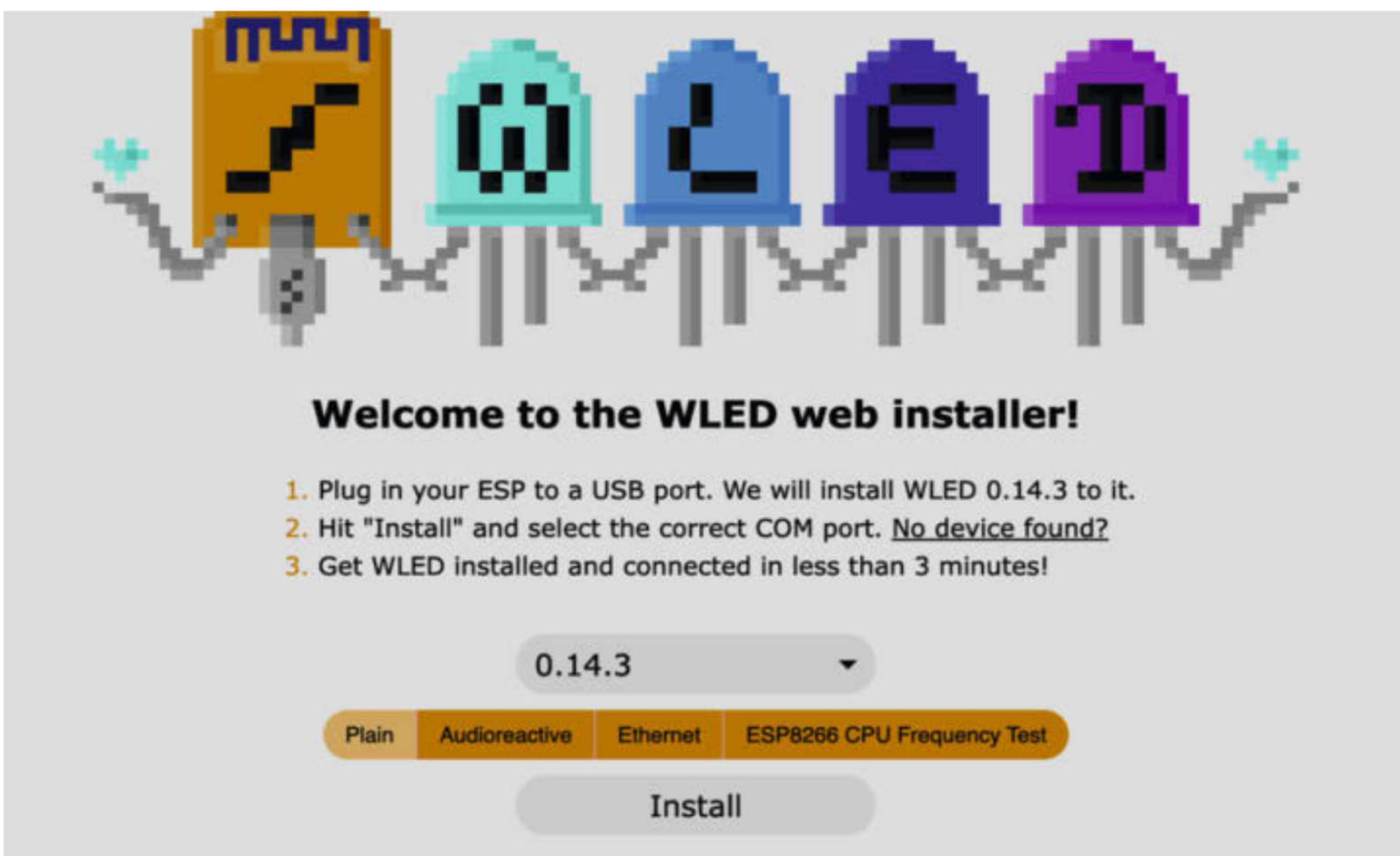
Bild 7: Die Installation von WLED funktioniert über einen Web-Flasher im Browser.
