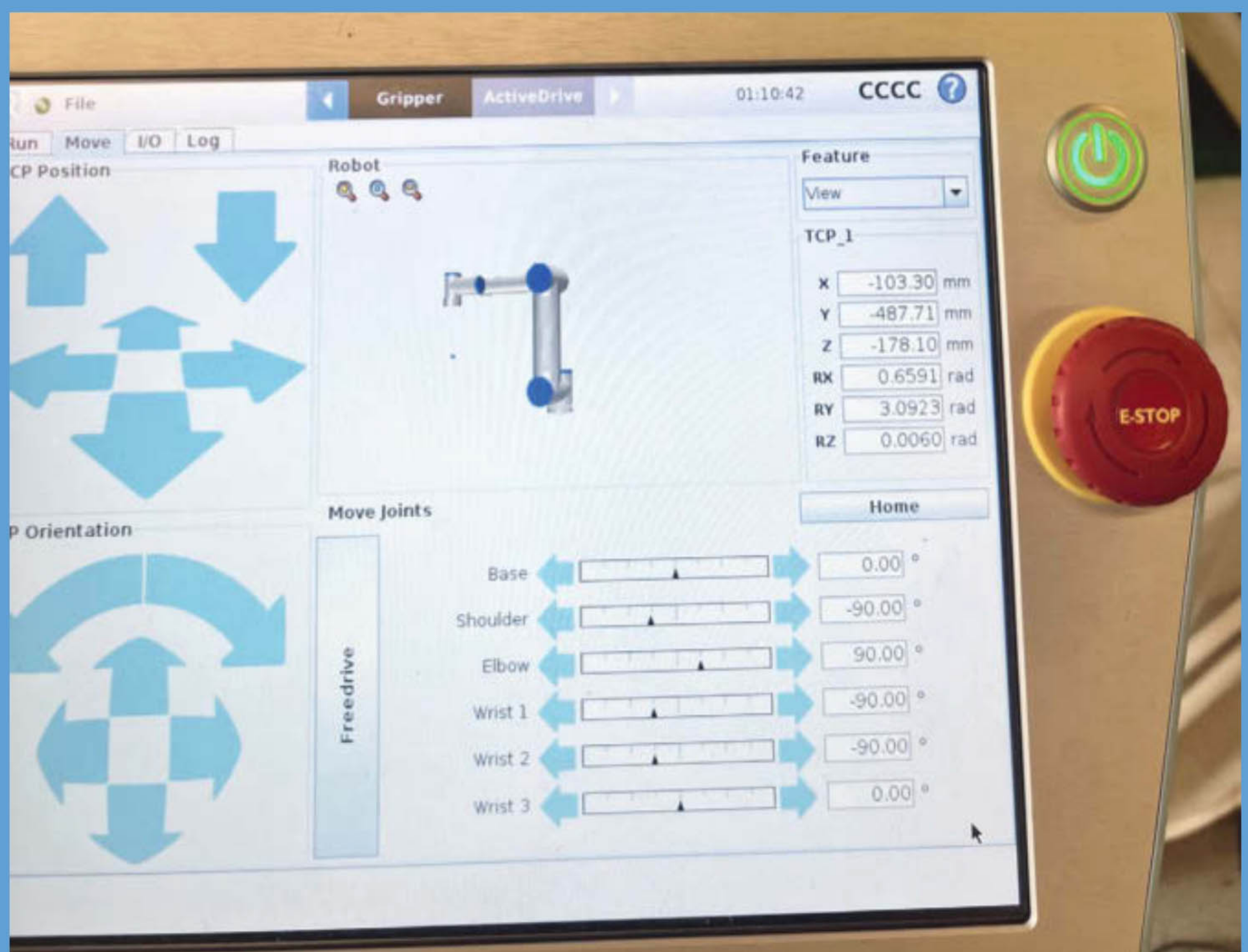
Über die frei verfügbare Software lassen sich die Roboterarme konfigurieren und steuern.
