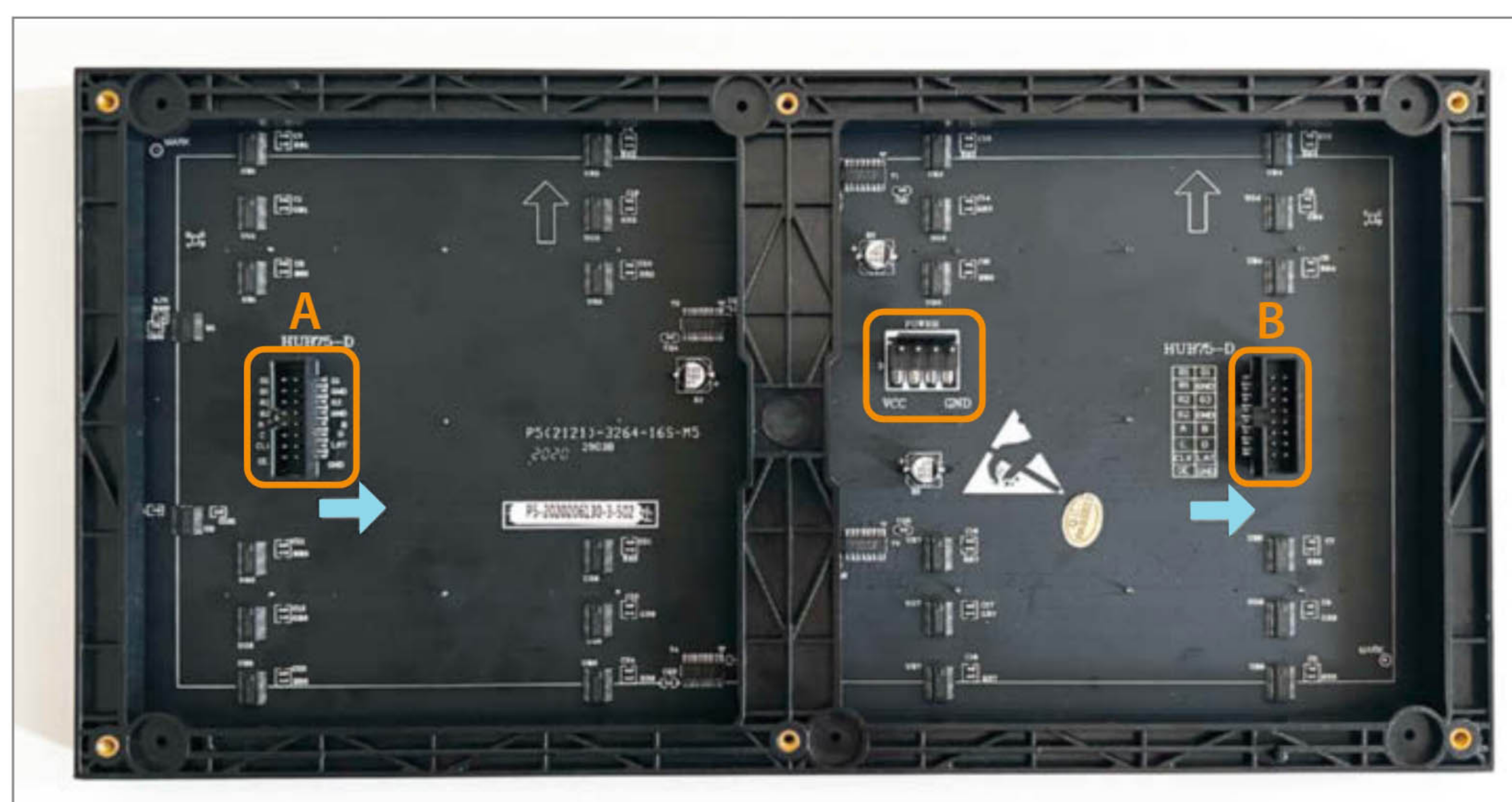
Bild 1: Die Rückseite eines HUB75-Panels. A ist der Dateneingang, an den man das Interstate 75 anschließen muss. B ist der Datenausgang, über den man (in Pfeilrichtung) weitere Panels verbinden kann. In der Mitte ist der Stromanschluss.
