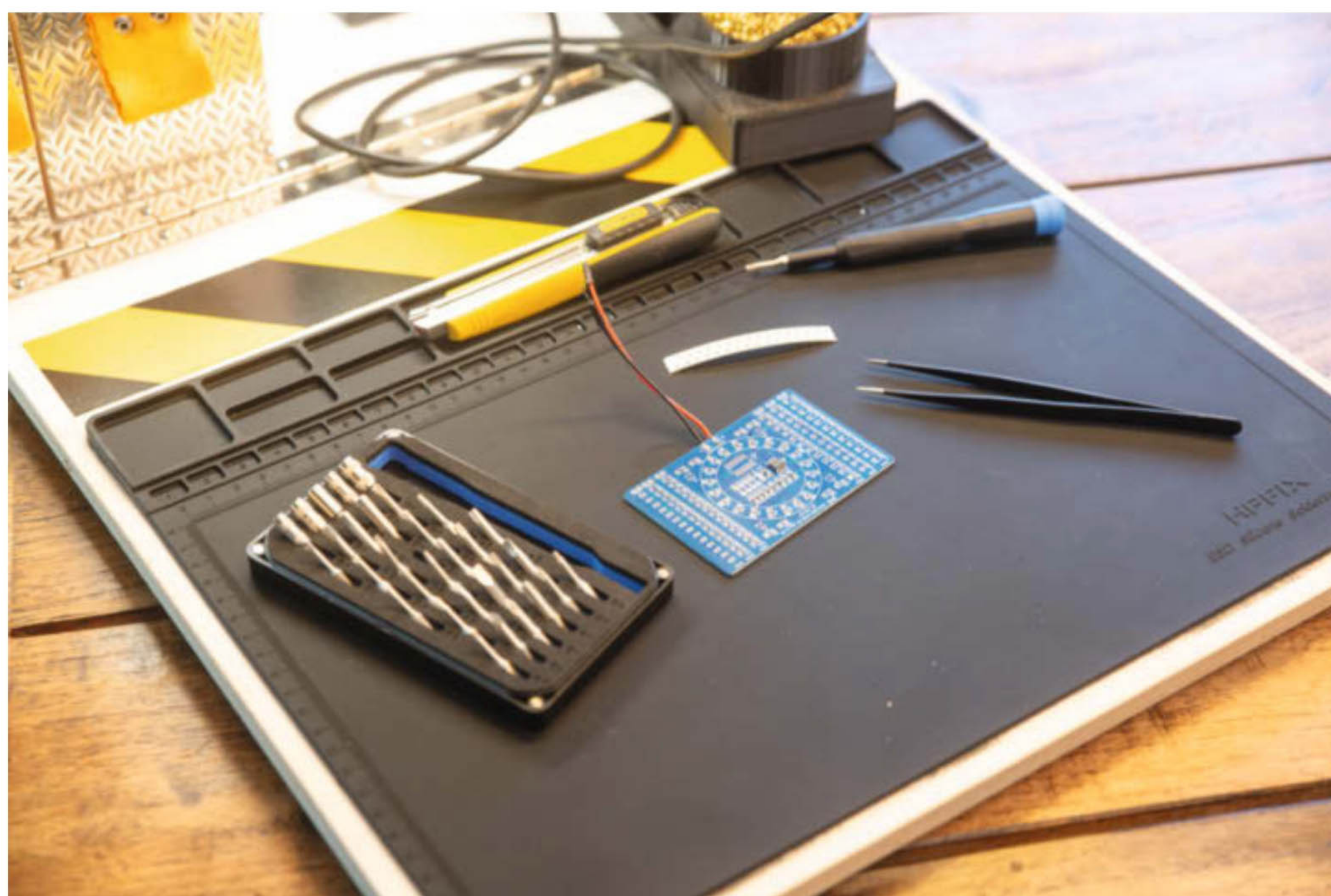
... um den Arbeitsplatz zu beleuchten. Die Lötmatte hat nummerierte Vertiefungen für kleine Bauteile. Legt man Schrauben bei der Demontage eines defekten Gerätes in der richtigen Reihenfolge ab, erleichtert das den anschließenden Zusammenbau.
