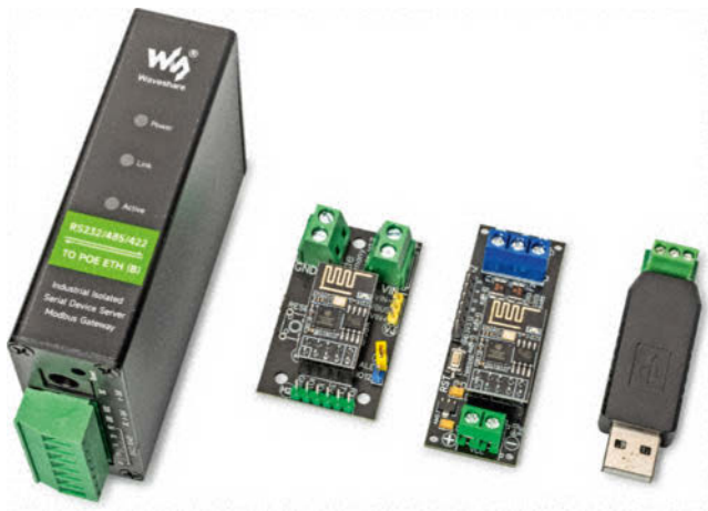
Modbus-Schnittstellen für verschiedene Gelegenheiten: Waveshare bietet Modbus-Gateways für die Hutschiene an (links), Bastler greifen zu ESP8266-RS485-Platinen für eigene Projekte (Mitte), zum Auslesen auf Raspi oder PC reicht ein günstiger RS485-USB-Adapter.
