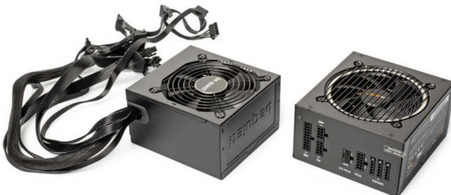
**Modulare Netzteile (rechts) sind meist teurer; sie sorgen für mehr Ordnung, da man nicht genutzte Kabel weglassen kann. Bei festen Kabelsträngen fällt aber ein Steckkontakt als Fehlerquelle weg.**
