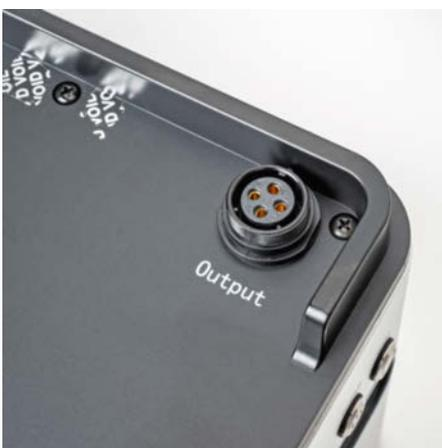
**Achtung: Die Anschlüsse für Ein- und Ausgang am Asgoff-Speicher ASE-1000 sind identisch. Schließt man am Output versehentlich die Solarmodule an, stirbt das Kommunikationsmodul.**
