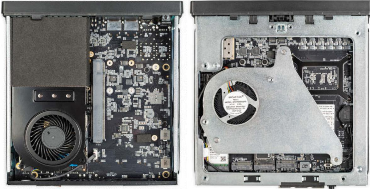
Das Mainboard des MS-01 sitzt in einer leicht lösbaren Schublade. Unter den CPU-Lüfter (links) kommen RAM-Riegel, umseitig sitzen bis zu drei M.2-SSDs. Der PCIe-Slot taugt am ehesten für schnelle Netzwerkkarten oder einen M.2-Träger bei hohem Massenspeicherbedarf.
