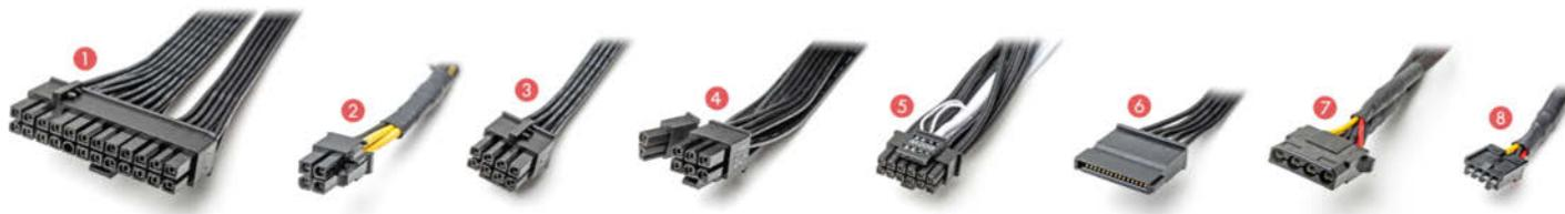
ATX-Netzteile haben Kabel mit diesen Steckern: ❶ Main Power ATX (24 Pole), ❷ ATX12V (CPU-Stromversorgung, 4 Pole), ❸ EPS12V (CPU-Stromversorgung, 8 Pole, oft teilbar und dann zu ATX12V kompatibel), ❹ PCI Express 8-polig, teilbar in 6+2, für Grafikkarten, ❺ 12VHPWR für Grafikkarten, fälschlich auch PCIe 5.0 oder ATX 3.0 genannt, ❻ SATA-Stromstecker für Festplatten und 2,5-Zoll-SSDs, ❼ 4-poliger „Molex-Stecker“ für alte Festplatten und optische Laufwerke, ❽ 4-poliger „Floppy-Stecker“.
