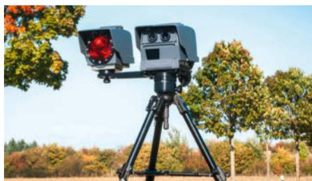
**Das Lidar-System Poliscan FM1 von Vitronic sieht von Weitem fast aus wie eine Fotokamera auf einem Stativ. Polizei und Ordnungsämter verwenden es vielerorts für mobile Geschwindigkeitskontrollen.**
