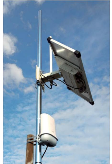
Das Milesight SG50 nimmt wenig Platz am Antennenmast ein. Sämtliche für den Betrieb nötigen Komponenten sind an einer Halterung.
