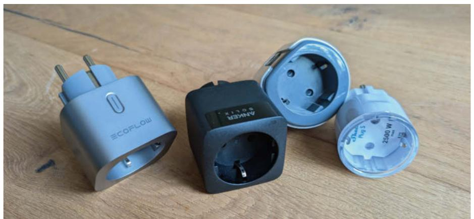
Mit smarten Zwischensteckern kann man bei EcoFlow und Anker Solix (von links) präzise einen einzelnen Verbraucher erfassen und gegensteuern. Bei Asgoft funktionierte das wegen der indirekten Ansteuerung des Wechselrichters nicht so gut. Shellys Smart Plug v2 (ganz rechts) wird bei Dyness und EcoFlow zwar erkannt, vom EMS allerdings nicht einbezogen.
