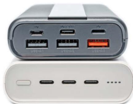
**Die Vrurc T2055 (oben) hat nur einen USB-C-Port, aber zwei Eingänge für Micro-USB- und Lightning-Ladegeräte. Von den unteren USB-A-Ports ist lediglich der orangefarbene schnellladefähig. Die Samsung-Powerbank stellt drei gleichberechtigte USB-C-PD-Ports bereit, ein USB-A-Ausgang fehlt.**
