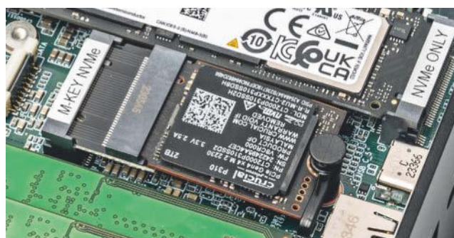
Lang gemacht: 2230er-SSD im längeren M.2-Slot
