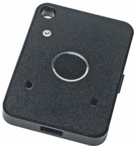
FIDO2-Authenticator mit Bluetooth-Direktverbindung wie den AllinPass FIDO2 gibt es bereits seit vielen Jahren.
