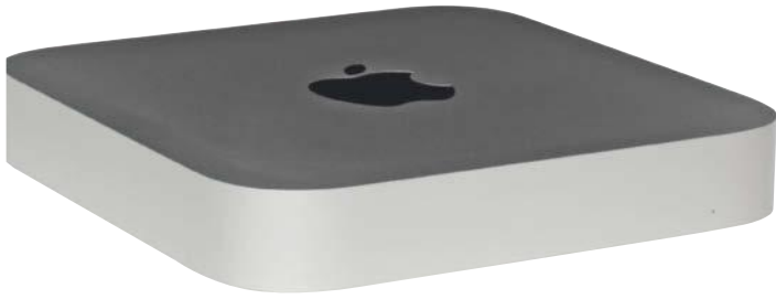
Der Mac Mini braucht deutlich mehr Stellfläche als viele andere Mini-PCs, allerdings baut Apple das Netzteil darin ein.
