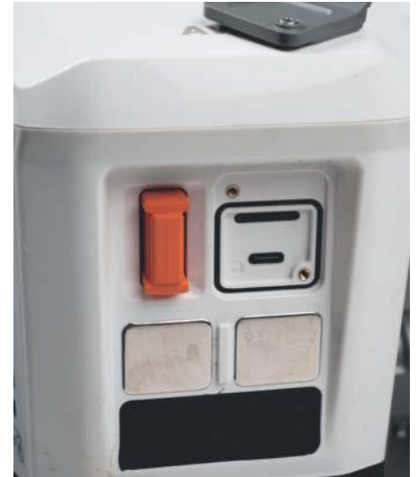
Ein Plastikschlüssel und mit SIM-Karte bestückbares 4G-Modul dienen als Zugriffs- und Diebstahlschutz, der sich aber leicht aushebeln lässt.
