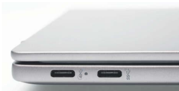
Kuriositäten mit USB: HP verwendet offizielle USB-Logos an seinen USB-C-Buchsen, doch bei unserem Testgerät funktionierte eine USB4-SSD an beiden Buchsen mit voller Geschwindigkeit und nicht nur an der hinteren.
