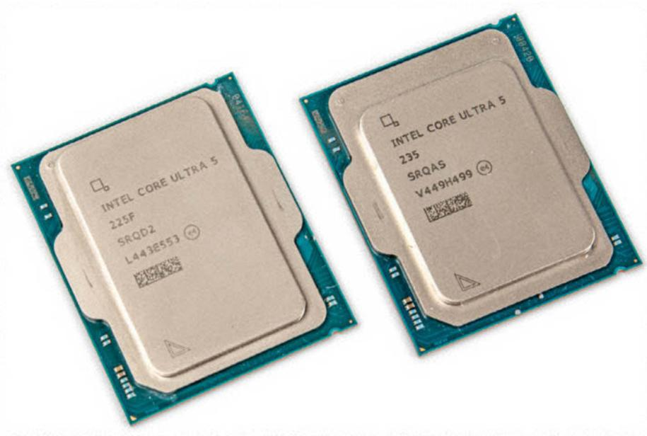
Für den Core Ultra 5 235 verwendet Intel einen etwas kleineren Heatspreader als beim Core Ultra 5 225F.
