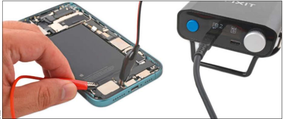
**Fingerübung:** Der Kleber, der den Akku des iPhone 16 im Gehäuse hält, lässt sich per 9V-Batterie lösen.
