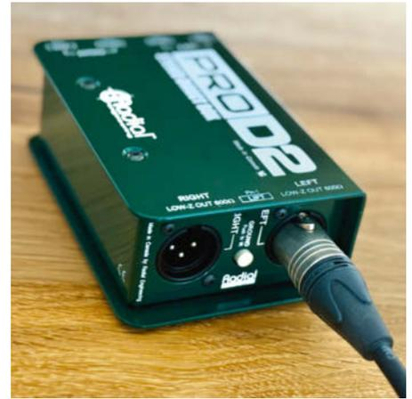
**Aktive Lautsprecher und Subwoofer neigen zu Brummschleifen. Diese können Sie mit passiven DI-Boxen und XLR-Kabeln mit symmetrischer Signalführung unterbrechen.**
