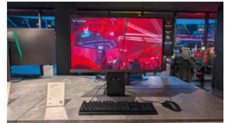
**LGs 4K-LCD-Monitor kann bei reduzierter Grafikkartenauflösung 480 fps wiedergeben. Für kontraststarke Inhalte unterstützt er DisplayHDR 600.**
