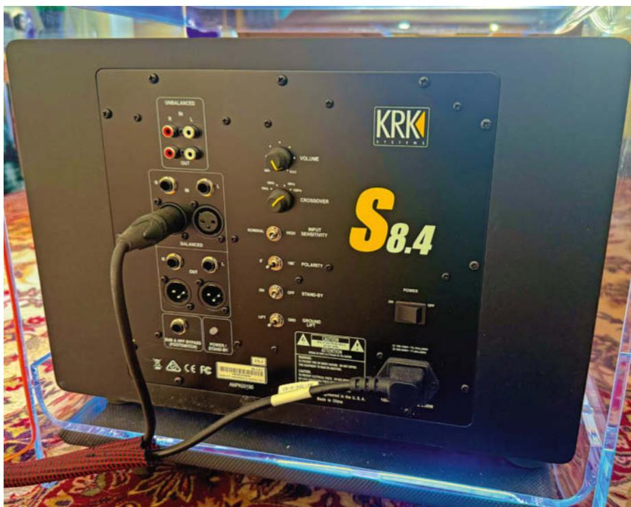
**KRK bietet für knapp 300 Euro günstige 8-Zoll-Subwoofer mit Class-D Verstärkern an, die sich auf der Rückseite mithilfe einer DI-Box auch per XLR verkabeln lassen. Zwei von ihnen sorgen in Verbindung mit einer passenden Frequenzkorrektur für eine gleichmäßige Bassverteilung im Raum.**
