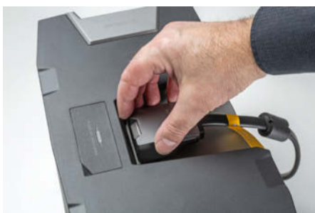
Schick, aber dysfunktional: In der Mulde der EcoFlow-Batterie bekommt man den DC-Stecker kaum gelöst.
