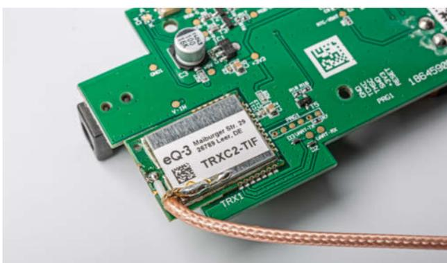
Der PigTail mit der SMA-F-Einbaubuchse wird direkt am Funkmodul angelötet. Die innere Ader ersetzt die Draht-Antenne, die Abschirmung kann man gut an der Metallhaube anlöten.
