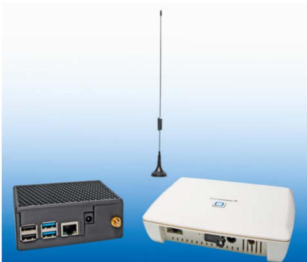
Links die neue Homematic-Zentrale auf Basis des Raspberry Pi 4 B und der RaspberryMatic-Software. Rechts die bislang genutzte CCU3 von eQ3.
