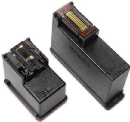
**Canon und HP verwenden Kombipatronen mit drei Tintenkamern für Cyan, Magenta und Gelb sowie integriertem Druckkopf. Die kleine Patrone des HP (links) enthält pro Kammer kaum drei Milliliter Tinte. Canons Druckköpfe (rechts) sind deutlich länger, was der Druckgeschwindigkeit zugutekommt.**
