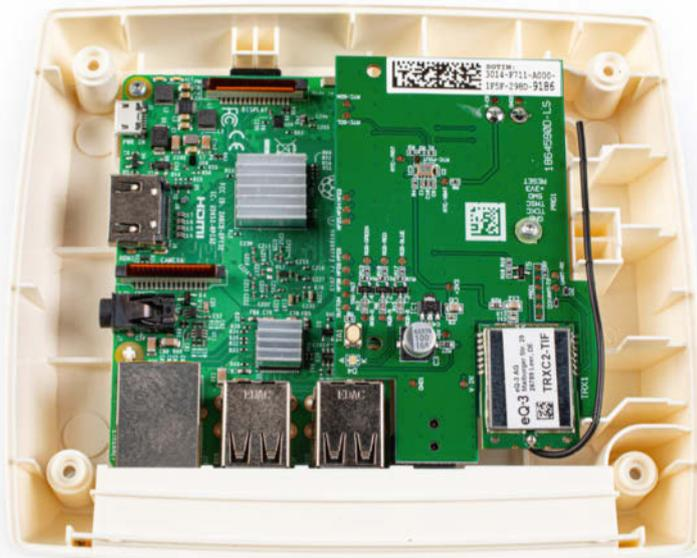
**Ein Blick in die CCU3 offenbart: Hier werkelt ein Raspberry Pi 3 B, auf dem eine Funkplatine sitzt.**
