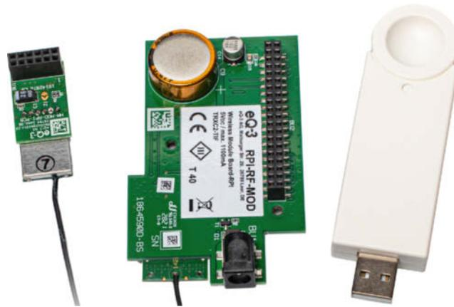
Eine Auswahl verschiedener Funkmodule für RaspberryMatic: links das einfachste Modell HM-MOD-RPI-PCB, in der Mitte RPI-RF-MOD und rechts ein USB-Stick mit integriertem Funkmodul (HmIP-RFUSB).
