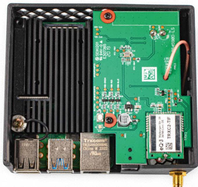
Im gut durchlüfteten 3D-gedruckten Gehäuse finden der Raspberry Pi 4 und das Funkmodul bequem Platz.
