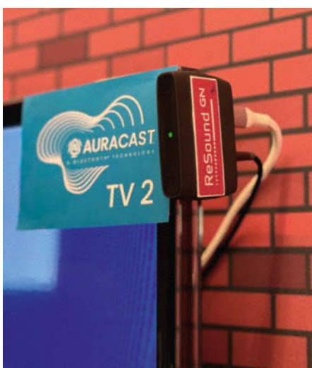
Fernseher lassen sich mit einem Auracast-Sender nachrüsten, der den Ton vom TV etwa über eine Cinch-Verbindung oder HDMI erhält.
