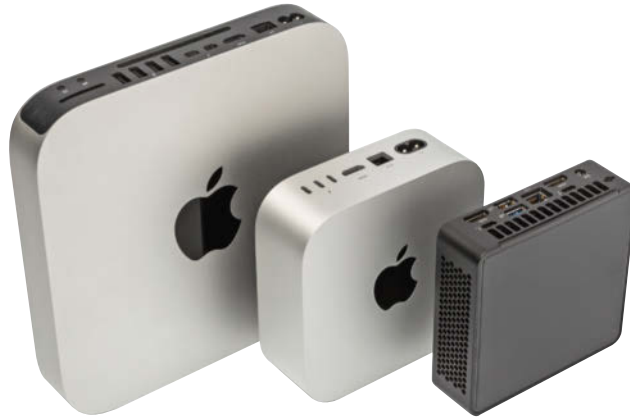
Geschrumpft: Der Mac Mini mit M4-Chip ist deutlich kleiner als sein Vorgänger, hat aber weiter ein eingebautes Netzteil – anders als der Asus NUC ganz rechts.
