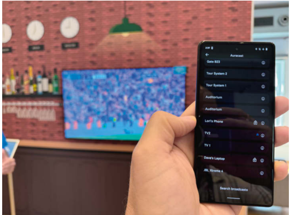
An einem Samsung-Smartphone mit Assistant-Funktion lässt sich für die gekoppelten In-Ears der gewünschte Auracast-Stream auswählen.
