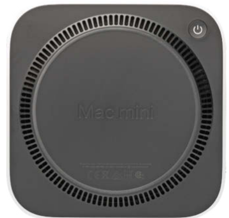
Idiotische Position: Der Einschalttaster sitzt hinten links unten am Gehäuseboden. Glücklicherweise braucht man ihn selten.
