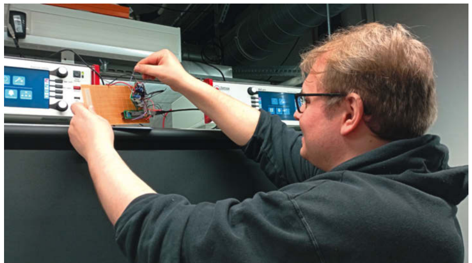
Doktorand Moritz Göb prüft die Kabel an einem Steuerelement, das die Gruppe aus einem PIC32 gebaut hat.
