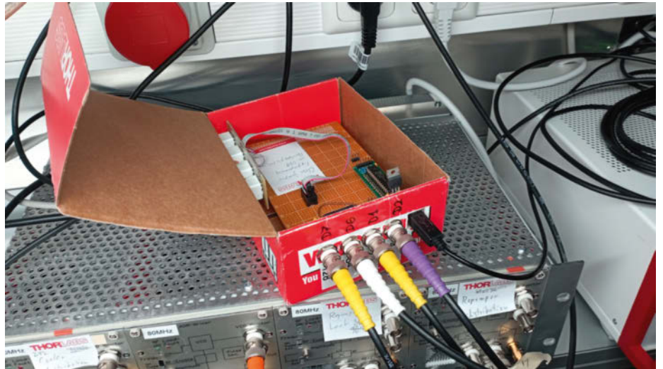
Kreatives Recycling: Aus einer alten Verpackung wird die Verkleidung eines Steuerelements auf Basis eines PIC32.
