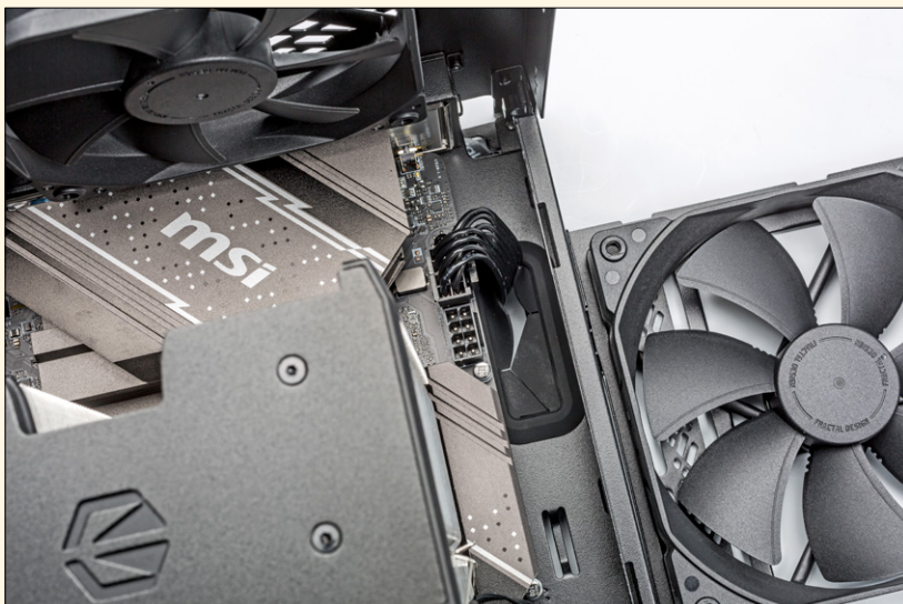
De ATX12V-stekker voor voeding van de cpu wordt vaak vergeten. Als die niet is aangesloten, start de pc niet.
