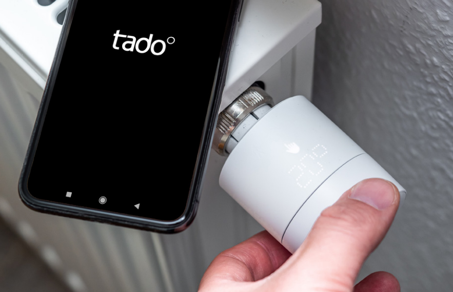
Zonder internetverbinding blijft de Tado-app hangen en blijven de thermostaatknoppen dom. Ze reageren dan alleen op handmatig instellen.
