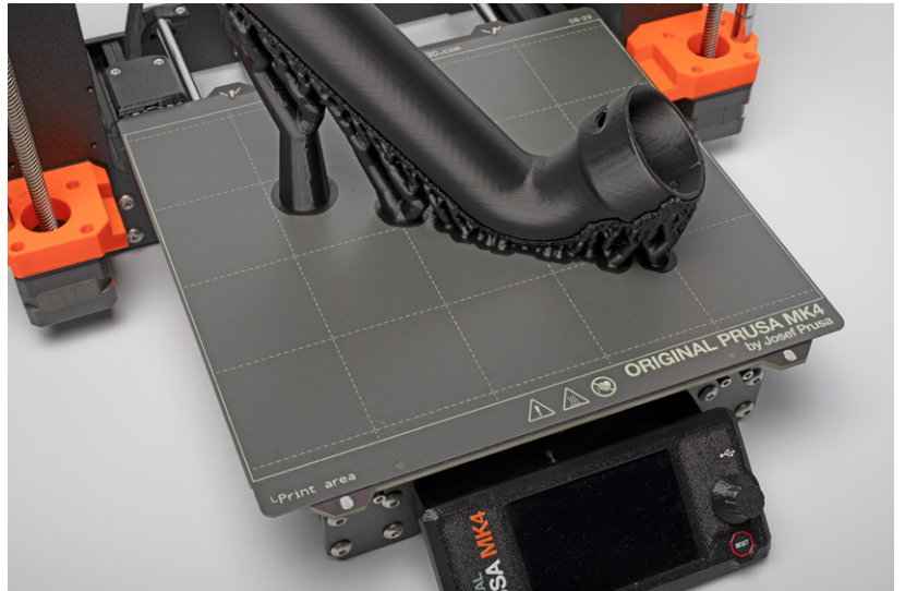
De Prusa MK4 is een bedslinger, waarbij het printbed met werkstuk over de Y-as naar voor of achter beweegt. Het ontwerp maakt een open constructie mogelijk, wat bij bepaalde materialen nadelig is.
