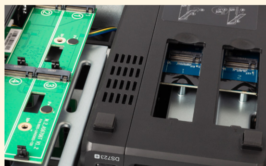
Sockets voor M.2-cache-ssd's maken deel uit van de basisuitrusting van een moderne NAS. Het loont echter niet altijd die te vullen.
