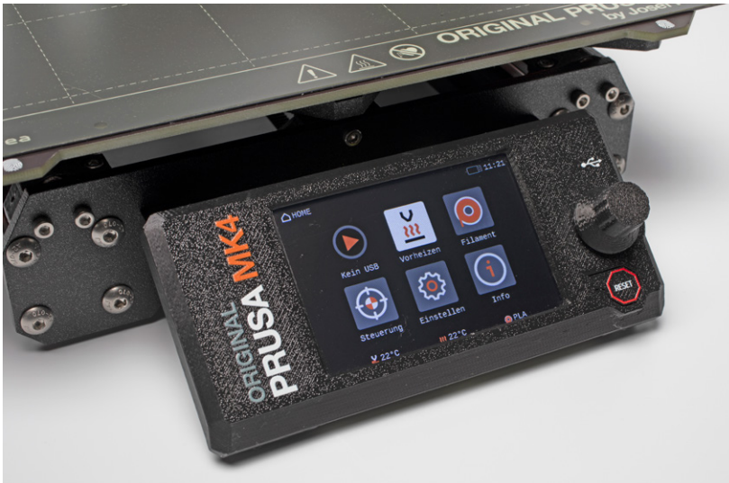
Het display van de Prusa MK4 toont een overzichtelijk menu dat je bedient met de draaiknop rechts. Het printen vanaf usb-stick met de knop starten vonden we het eenvoudigst. Er is ook een webinterface.
