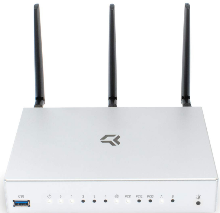
Het opensource routerbesturings-systeem staat standaard geïnstalleerd op een Turrís Omnia, maar het is op veel en ook oudere routers te installeren.
