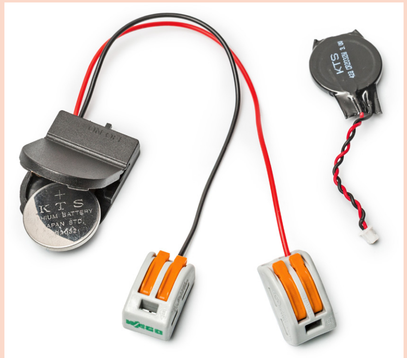
Losse houders voor CR2032-knoopcelbatterijen kunnen uitkomst bieden wanneer een oudere pc de BIOS-instellingen en de tijd vergeet.
