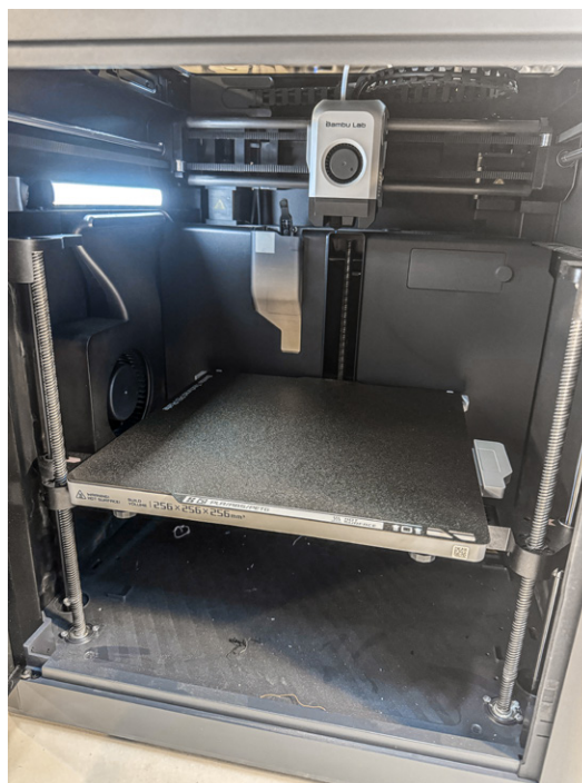
De Bambu Lab P1S is een CoreXY-printer. De motoren voor de X- en Y-as zijn bevestigd aan het frame, het printbed beweegt alleen verticaal. Dat maakt veel snellere prints mogelijk dan bij de Prusa.
