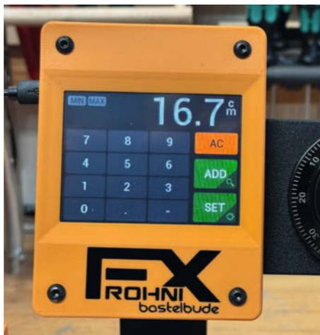
Die kleine, abgedunkelte Ecke bei den Buttons ADD und SET dient als Hinweis auf die Funktion beim Gedrückthalten der Schaltfläche.
