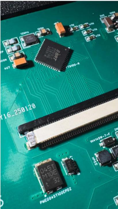
Der FT810-Grafikchip sowie die 54-Pin-Schnittstelle für das Display.
