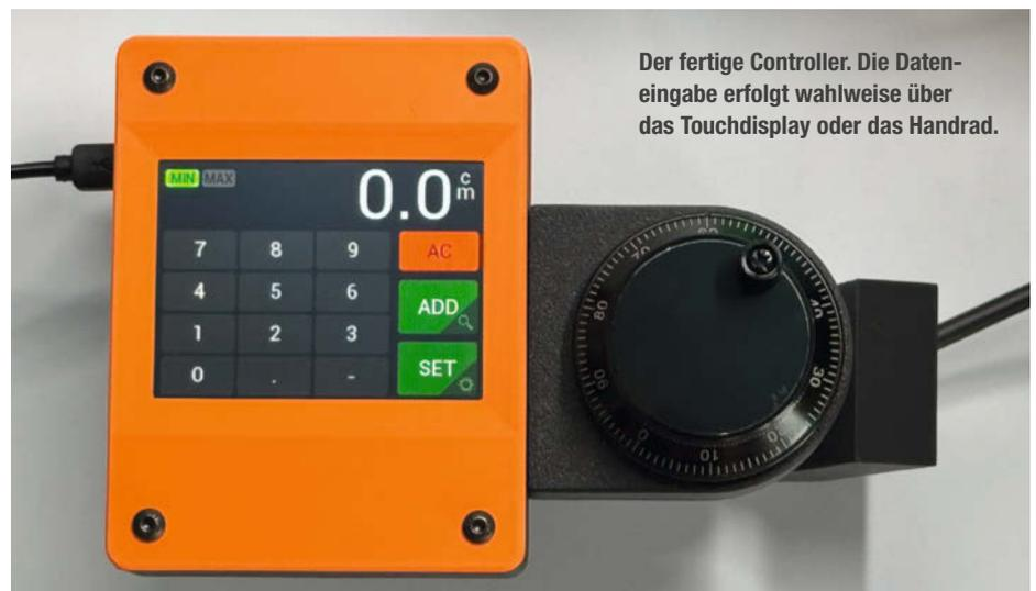
Der fertige Controller. Die Dateneingabe erfolgt wahlweise über das Touchdisplay oder das Handrad.
