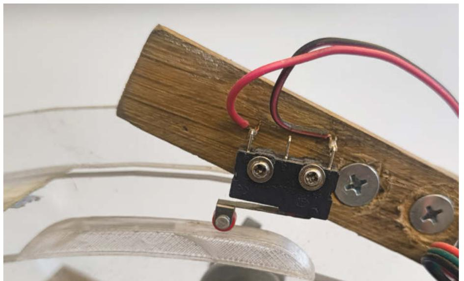
Bild 14: Nachdem ein Ei gelegt worden ist, wird der Rollenhebel durch den Nocken nach oben gedrückt und der Motor bleibt stehen.
