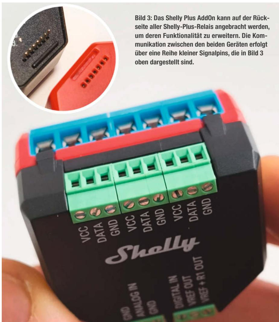
Bild 3: Das Shelly Plus AddOn kann auf der Rückseite aller Shelly-Plus-Relais angebracht werden, um deren Funktionalität zu erweitern. Die Kommunikation zwischen den beiden Geräten erfolgt über eine Reihe kleiner Signalpins, die in Bild 3 oben dargestellt sind.
