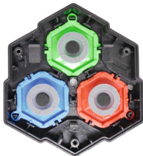
**Bild 5:** Bei Entfernung der Taster sollte man sich die Farbreihenfolge merken.
