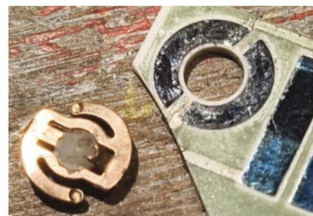
**Bild 7: Kreisförmiger regelbarer Widerstand, mit dem der Drehzahlregler nach der Fertigstellung kalibriert wird.**
