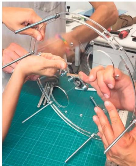
Bild 9: Für das äußere Gehäuse benötigt man die sechs längeren Gewindestangen.
