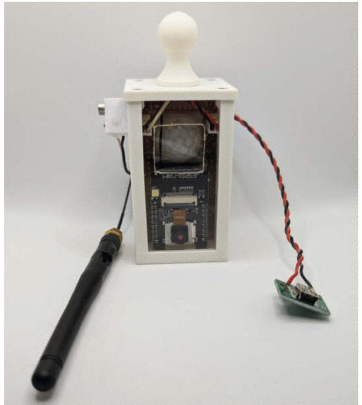
Bild 10: ESP32-CAM-Node.
