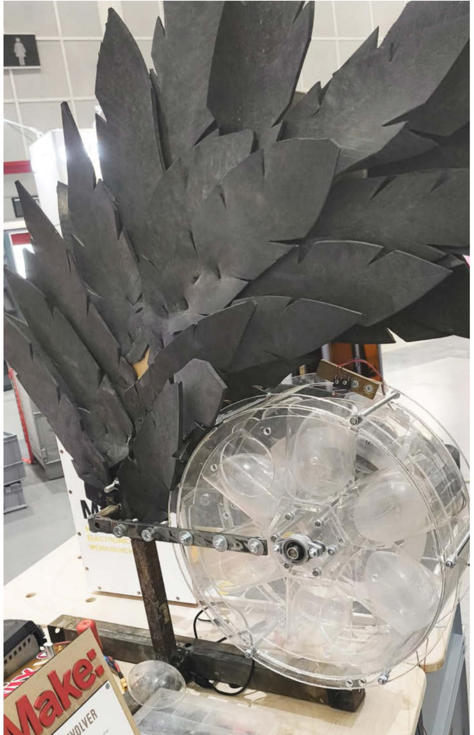
Bild 15: Damit der Eierrevolver nicht umfällt, muss der Standfuß unter dem Zylinder hervorstehen.
