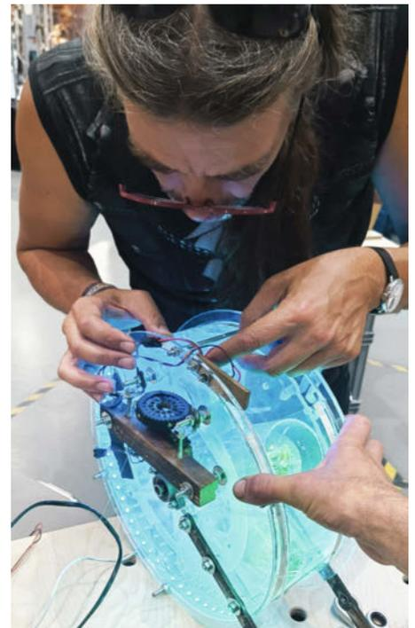
Bild 11: Wir haben die selbstklebenden WS2812-LEDs an den Innenseiten der Abdeckungen angebracht.
