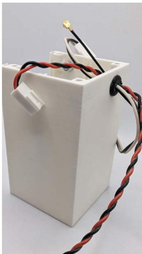
Bild 11: Rückseite eines ESP32-CAM-Nodes.
