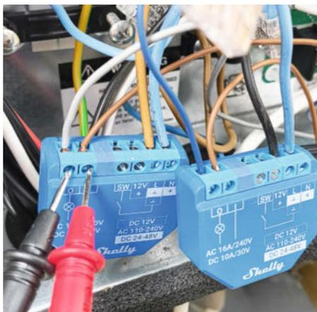
Bild 12: Zwei Shelly Plus 1 werden verwendet, um die beiden Bits in der Wärmepumpe zu schalten.
