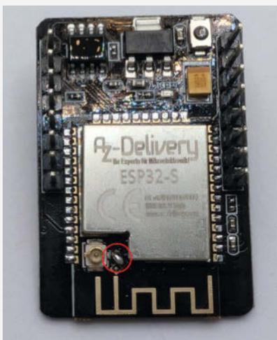
Widerstand umlöten oder, wenn man das winzige SMD-Bauteil sofort nach dem Auslöten verliert, mit einem Lötzinnpatzen ersetzen.
